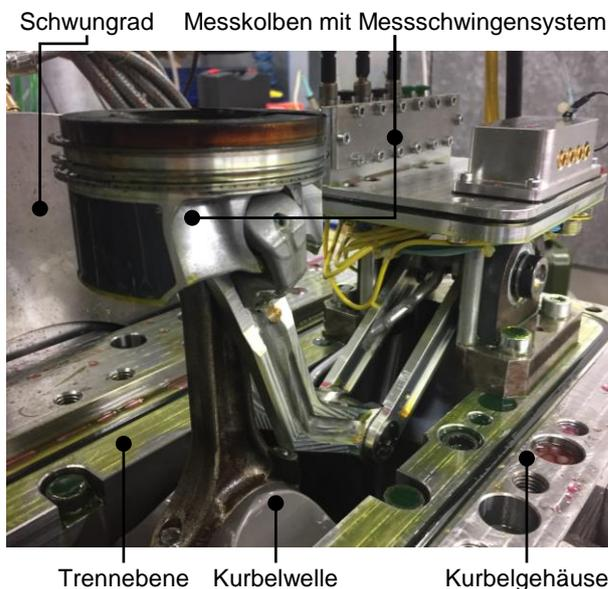
Abbildung 12: Motor mit abgetrenntem Zylindergehäuse für den Umbau der Kolbengruppe
