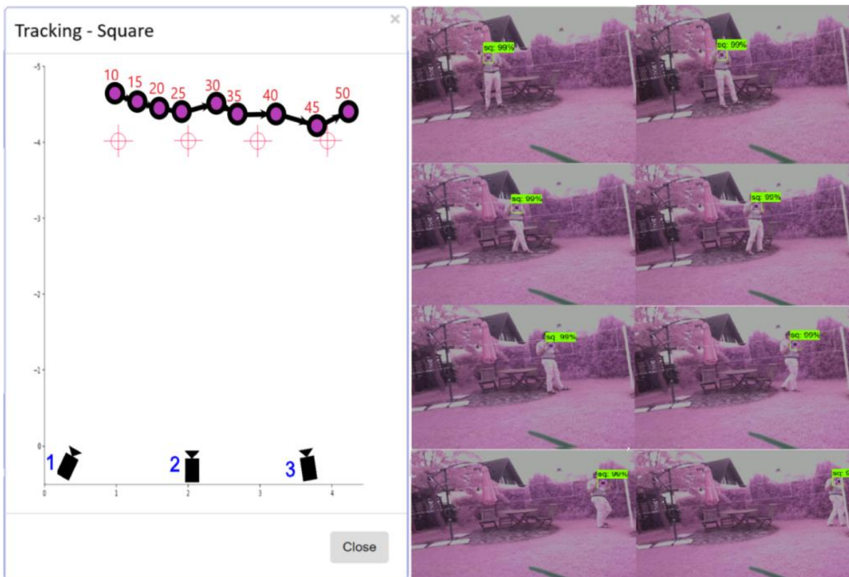
Abbildung 6.6 Trackingmarker wird hinter dem Schnurgerüst vorbeibewegt (rechts). Resultierende Grafik der Webapplikation (links) (Eigene Grafik)
