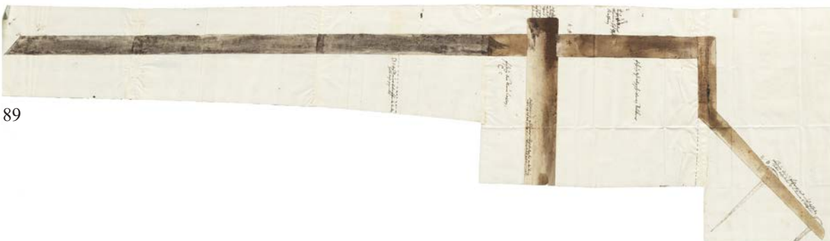
88a/b & 89 | Michael Kurzrauch, Entwürfe der Schrauben zu Dachwerk und Boden im Saal aus Bauphase III.2, oben (88a) die Schraube, die im Durchzug steckt (Detail Schraubenkopf s. VIII.86), Mitte (88b) Schraube im Boden unter dem Saal (Detail Schraubenkopf s. VIII.87), unten (89) Dachschraube, die den Sparren fixiert, maßhaltige, lavierte Tuschezeichnungen auf Papier, 1639; Plansatz mit VIII.82-87 | © HZAN La 40 Bü 733
