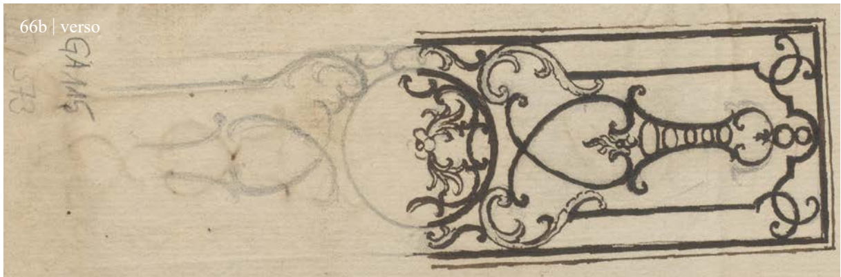
66a/b | Carl August von H.-Kirchberg (?), Entwürfe für die Fensterbrüstungen am vorderen Schlossbau aus Bauphase IV.2c (untere Variante leicht variiert umgesetzt, s. VII.5), Tusche auf Papier, um 1759; alternativer Entwurf s. V.67 | © HZAN GA 115 III Nr. 848 (Vorder- und Rückseite)
