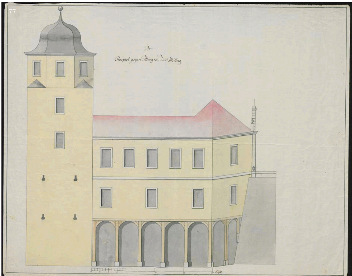
76 & 77 | J. C. Rösch, Entwurf für die ehemalige Holzremise am hinteren Schlosshof aus Bauphase IV.3b in Ansicht (77), Grundriss und Schnitt (76), kolorierte Tuschezeichnung auf Papier, 1802 | © HZAN GA 115 III Nr. 629 & 630
