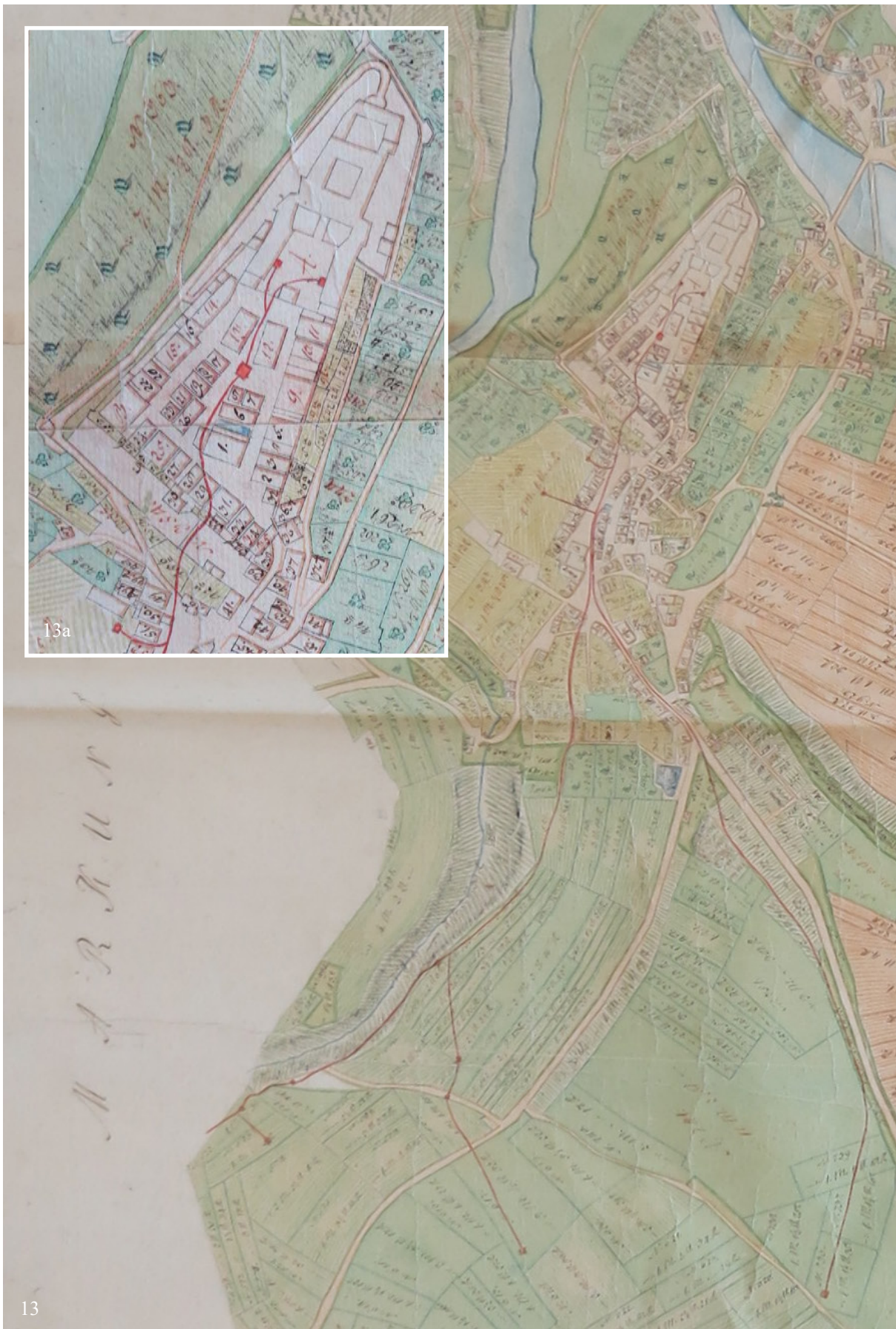
13 & 13a | Geometer Fuchs, Ausschnitt aus dem „Geometrischen Plan über die Markung Kirchberg“, in Rot die städtischen Brunnen und Wasserleitungen, die von der Anhöhe im Südwesten in die Stadt führen, kolorierte Tuschezeichnung, 1818, im Detail (13a) die Altstadt mit der Wasserleitung von Stadt- und Schlossbrunnen | © HZAN GA 100 Nr. 177
