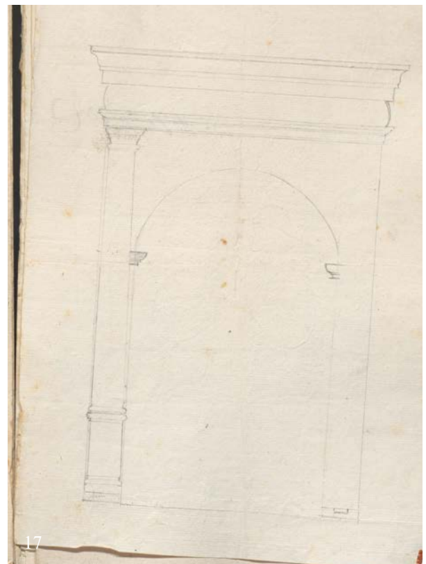
16 & 17 | Zwei Entwürfe zu den Fensterrahmen am Eberhardsbau, links (16) mit geohrten Ecken, rechts (17) als Ädikula mit geradem Sturz, je Bleistift auf Papier, 1710/11 | © HZAN Ki 35 Bt 2396 zu Nr. 43
