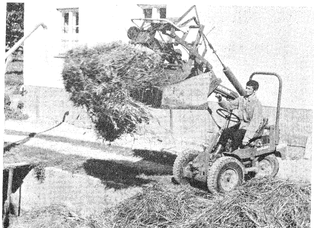
Abb. 7: Abschleudern der Schaufelfüllung durch Federspannung. Die Stapelhöhe beträgt etwa 2 m, die Wurfweite je nach Gewicht der Schaufelfüllung bis zu 4 m
