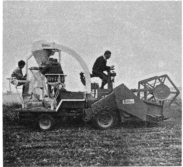
Bild 1: Parzellenhäcksler im Einsatz Der hohe Fahrersitz bietet eine sehr gute Sicht
