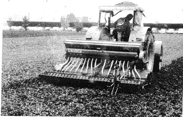
Abb. 13: Packerwalzen verdichten den locker gefrästen Boden und schaffen den für die rasche Keimung notwendigen Bodenschluß.
