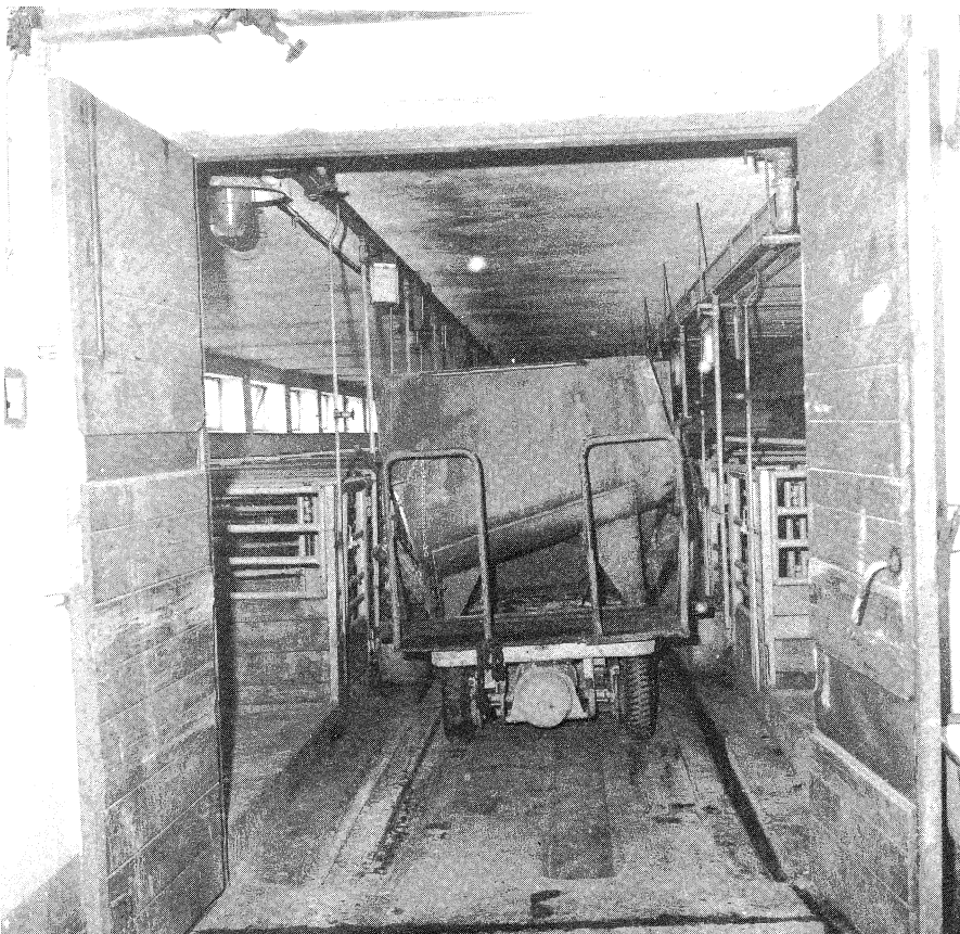
Bild 7: Mobiler Fütterungswagen für Flüssigmistfütterung. Eine mitfahrende Bedienungsperson teilt das Futter in die Tröge zu.
