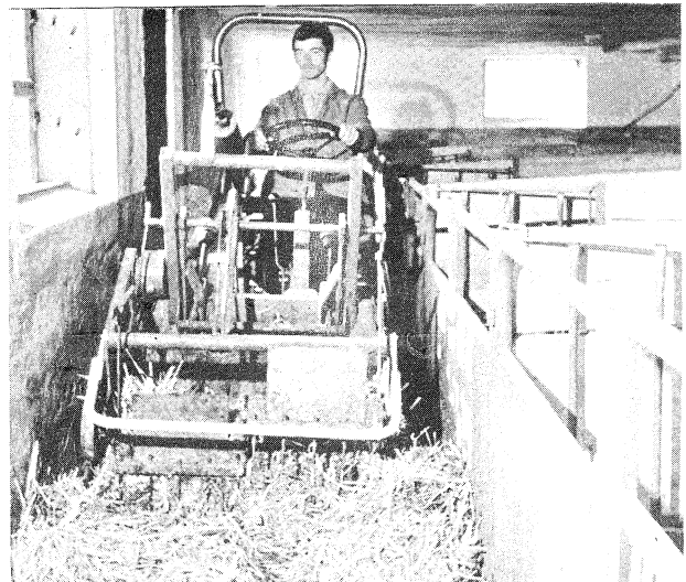
Abb. 6: „Eichus HD 12“ beim Entmisten eines Schweinezuchtstalles mit dänischer Aufstallung und schmalem Mistgang. Die Misthaufel wird durch den angetriebenen Zubringer gefüllt
