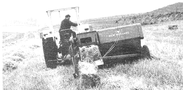
Abb. 4: Gedrehte Ablage der Hochdruckballen für die Aufnahme durch einen Ballenladewagen System New Holland
