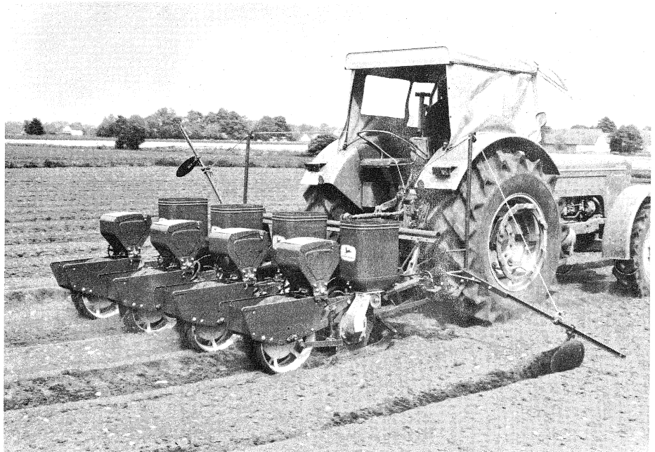
Abb. 1: Amerikanisches Gerät mit gesteuerten Klemmfingern.
