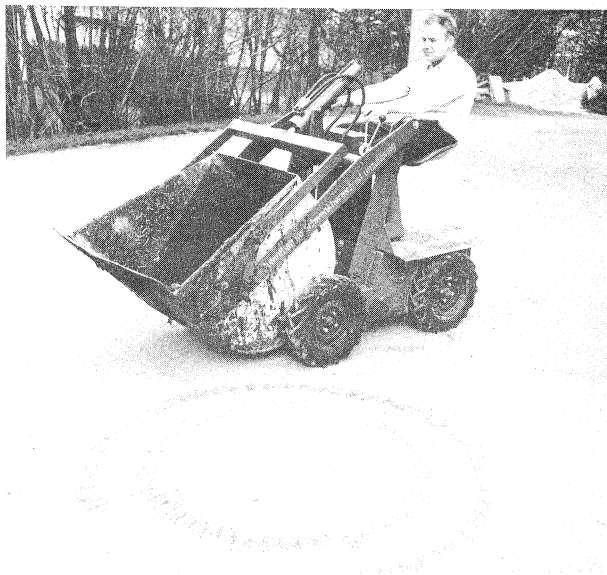
Abb. 3: Kompakter, wendiger und leistungsfähiger Stallschlepper „Andi“ mit Batterieantrieb. Durch die einem Raupenfahrzeug ähnliche Lenkung kann das Gerät auf der Stelle drehen, wie der Spurkreis im Vordergrund zeigt. Die schwenkbare Schaufel erlaubt auch den Transport sehr einstreuer, flüssigeren Mistes
