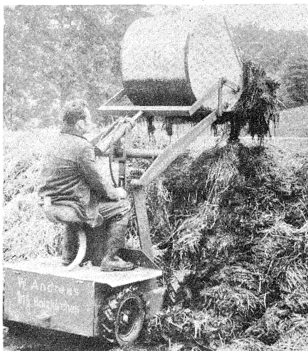
Abb. 4: Stapeln des Mistes mit batteriegetriebenem Stallschlepper. Die Schaufel kann elektro-hydraulisch geschwenkt werden und stapelt den Mist je nach Konsistenz auf 1,8 bis 2 m Höhe
