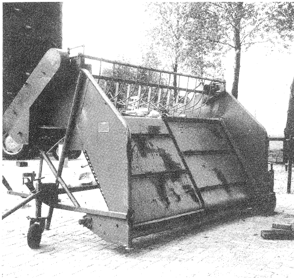
Stationäres Dosiergerät, das direkt vom Ladewagen beschickt wird. Bei Schnellentleerung muß noch ein Zuführtuch angebracht werden.
