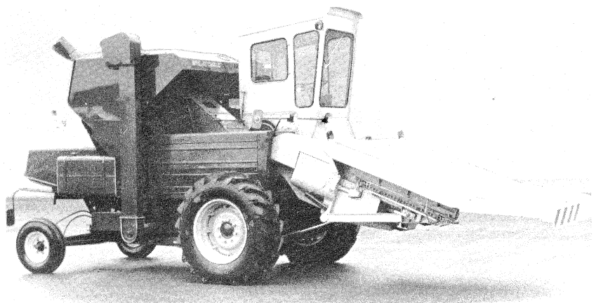
Selbstfahrende Spezialmaiserntemaschine finden neuerdings dort verstärktes Interesse, wo größere Maisflächen zu ernten sind und hohe Abnutzungen am Mähdrusch befürchtet werden
