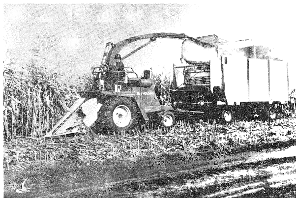
Bild 3. Selbstfahrer-Trommelfeldhäcksler mit Schneid-Wurf-Trommel (dreireihiger Mais-Mähvorsatz); bei schwierigen Gelände-verhältnissen im Parallelbetrieb.
