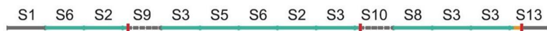
Abbildung 9.2: Finale Situationsrandomisierung und Aufteilung der Versuchsstrecken (S1=Autobahnaufahrt, S2=Followfahrt, S3=Freie Fahrt, S4=Baustelle- Ersatzfahrbahnmarkierungen, S5=Geschwindigkeitsbegrenzung, S6=Stau, S7=Baustelle-Reißverschluss, S8=Überholmanöver, S9=Regen, S10=Fehlende Fahrbahnmarkierung, S11=Notbremsung, S12=Sensorausfall, S13=Autobahnabfahrt)
