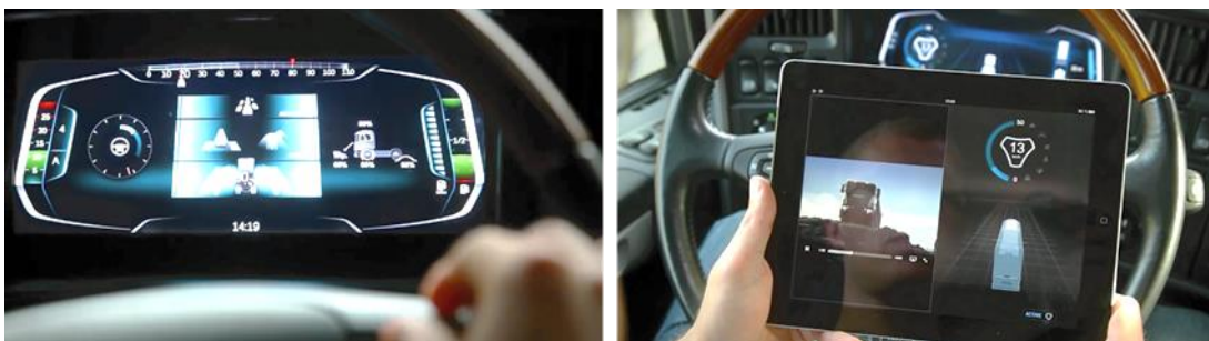
Abbildung 2.22: Anzeigekonzept Scania - Active Frame. Darstellung Kombidisplay (links) und Tablet (rechts) [104, S. 26, 109]
