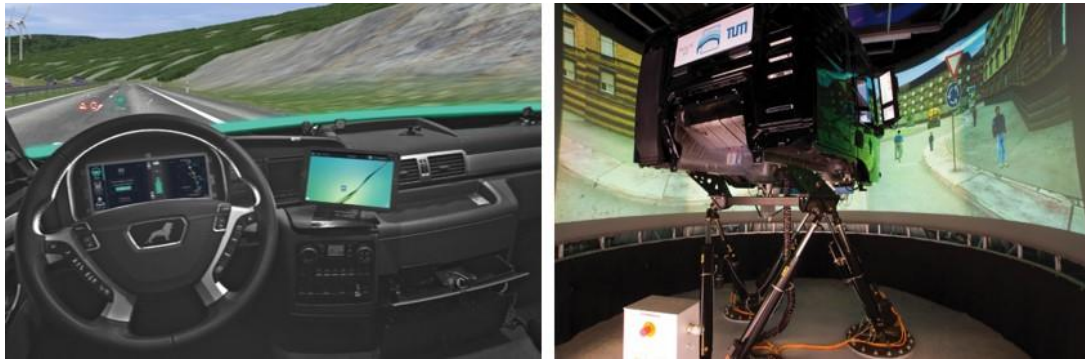
Abbildung 6.6: Dynamischer Fahrsimulator: Ansicht von innen (links), Fahrerkabine mit Bewegungssystem und 210° Sichtsystem (rechts)
