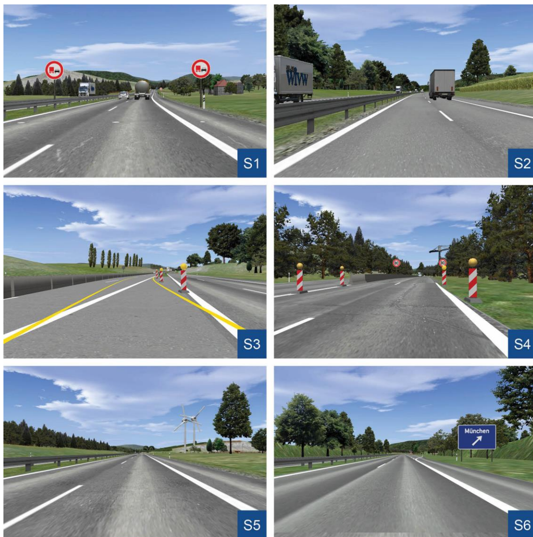
Abbildung 9.1: Überblick zu den sechs Szenarien in der Fahrsimulation v. l. n. r.: Freie Fahrt mit anschließender Folgefahrt (S1), Überholmanöver (S2), Baustelle (S3), fehlende Fahrbahnmarkierungen (S4), Freie Fahrt mit Sensorausfall (S5), Autobahnabfahrt (S6)
