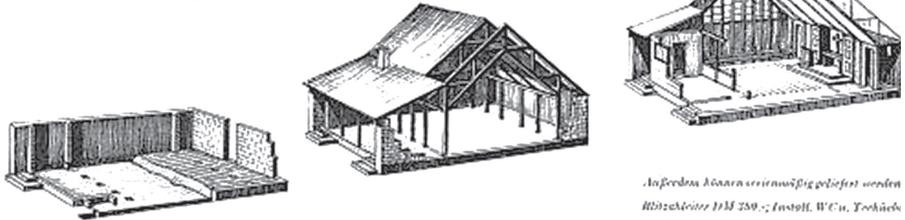
Abb. 55: Isometrische Darstellung des Konstruktionsaufbaus einer Diasporakapelle mit Kostenaufstellung, 1950
