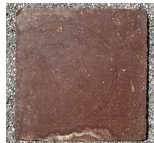
Abb. 83: Holz-Zementfliesen (Abmessungen 25 x 25 x 2 cm)
