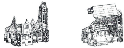
Abb. 28: Einbau einer Notkirche in einen teilzerstörten Vorgängerbau, Hamburg-Hoheluft 1948-1949
