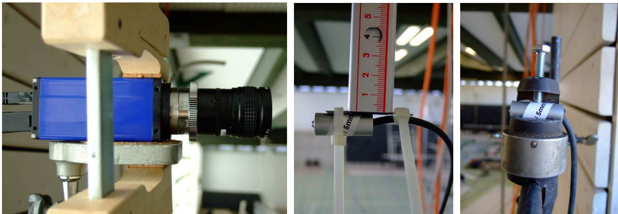
Abbildung 13: Vorversuche in der Turnhalle in Murnau: Kamera (links), verschiebliche Mess-LED (Mitte) und Referenz-LED (rechts)
