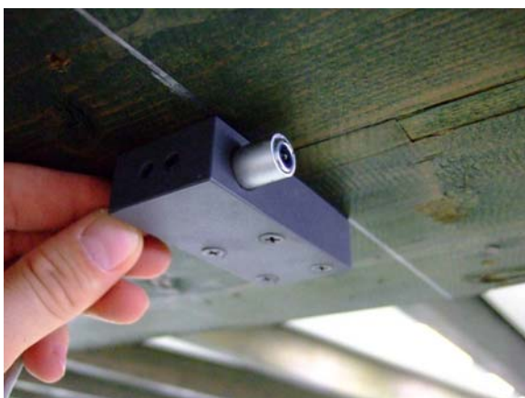
Abbildung 21: LED eines Messpunktes während der Montage mit Halterung aus Stahl
