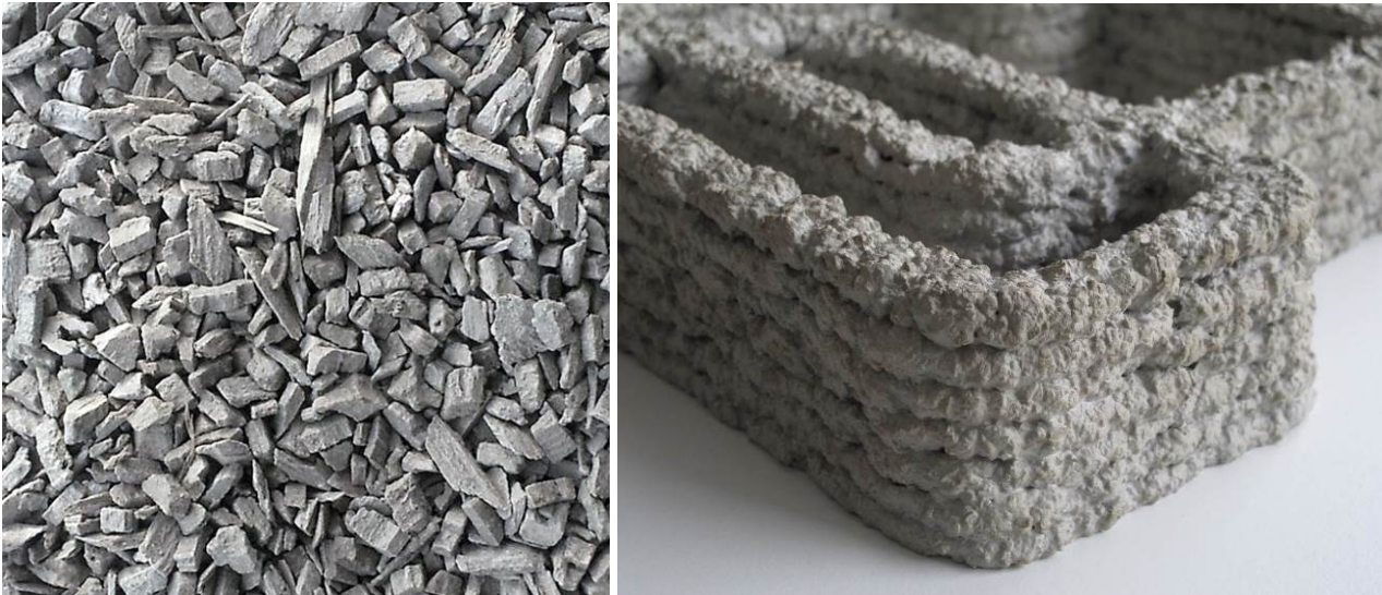
Abbildung 58: Mineralisch ummantelte Späne CEMWOOD CW 1000 (links) und durch Extrusion eines Leichtbetons mit der Gesteinskörnung CEMWOOD CW 1000 gefertigtes Bauteil (rechts) (Modell aus Immel 2015)
