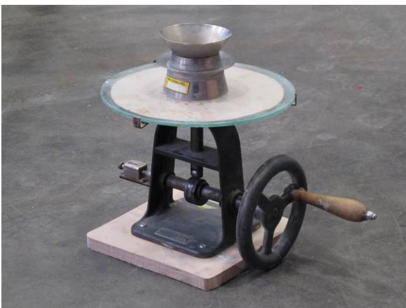
Abbildung 60: Höggermann-Ausbreittisch für Handbetrieb, mit Zählwerk, Glasplatte und Setztrichter mit Aufsatz
