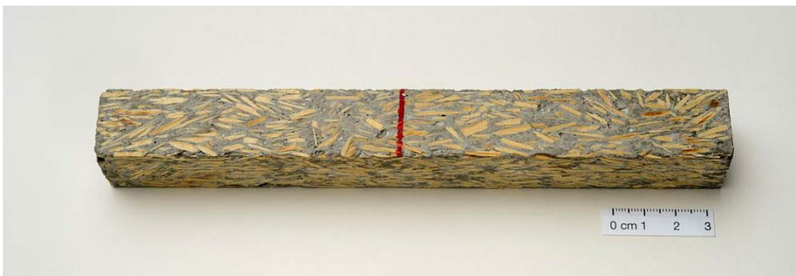
Abbildung 94: Prüfkörper mit parallel zur Längsachse des Prüfkörpers ausgerichteten Spänen
