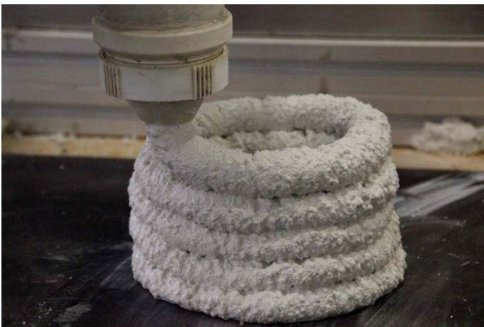
Abbildung 59: Extrusion von Leichtbeton mit der Gesteinskörnung Blähglasgranulat (Mischung 3 in Bild Abbildung 61) (Martius 2015)
