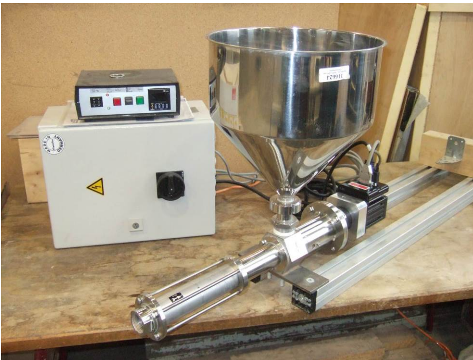
Abbildung 70: Extruder I mit ViscoTec Dispenser 3VMP22 liegend aufgestellt und mit unmittelbar aufgesetztem Edelstahltrichter, links im Bild die elektronische Steuerung (Bauer 2015)
