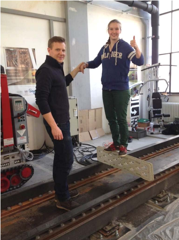
Abbildung 75: Ergebnis eines Vorversuchs mit sechs Schichten der Schichtgeometrie A, Demonstration der Festigkeit durch Einsatz als Träger über eine Spannweite von 70 cm
