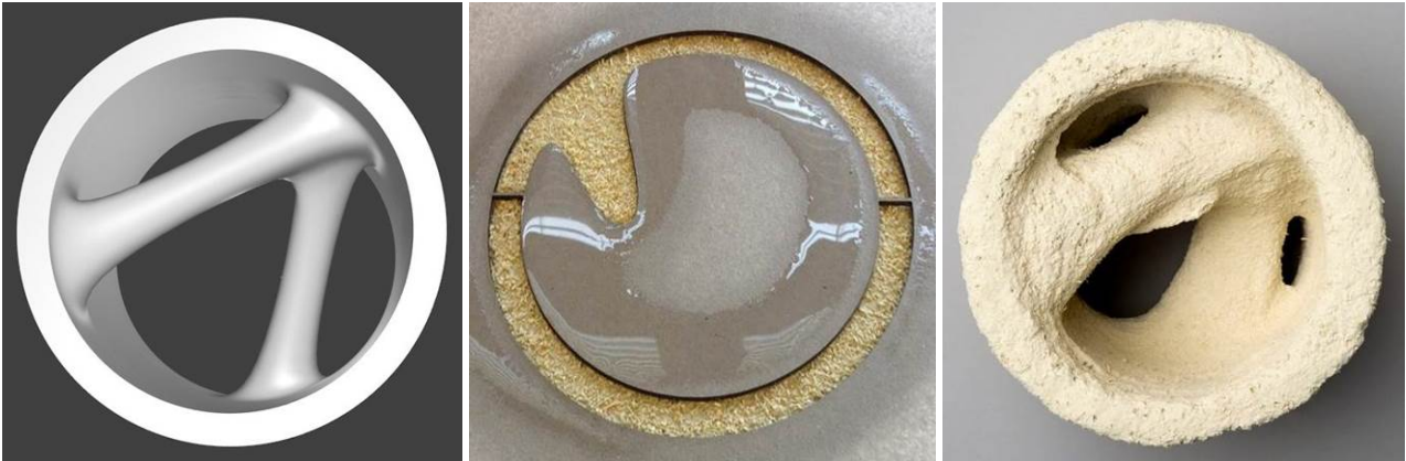
Abbildung 103: Arbeitsschritte bei der Herstellung des Demonstrationsobjektes ‚Rohr mit inneren Verstrebungen‘ durch selektives Binden von Holzspänen mit Zement in der Variante selektive Aktivierung: auf Grundlage des digitalen Modells (links) wurden aus Graupappe mit dem Lasercutter 50 verschiedene Schablonen hergestellt, eine Schablone mit einem der jeweiligen Schichtgeometrie entsprechenden Ausschnitt wurde auf die Schicht aus Span-Zement-Trockengemisch aufgelegt und Aktivator (Wasser) aufgesprüht (Mitte) (Schablone und Bild Medele 2014), nach Abbinden des Zementes und Entfernen des nicht gebundenen Materials konnte das fertige Objekt dem Bauraum entnommen werden (rechts) (Modellbau Medele 2014, Foto R. Rosin, HFM)
