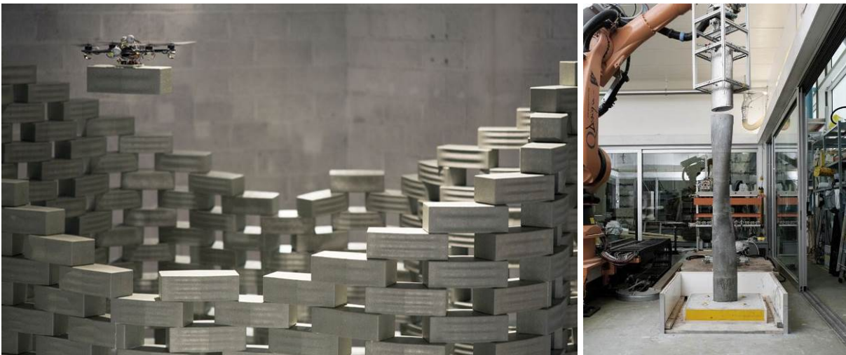
Abbildung 17: Gramazio & Kohler: Stapeln von Modulen mit Flugrobotern ‚Flight Assembled Architecture‘ 2011 - 2012 (Gramazio Kohler 2016d) (links) und digitales Betongleitbauverfahren ‚Smart Dynamic Casting‘ 2012 - 2015 (Gramazio Kohler 2016e)
