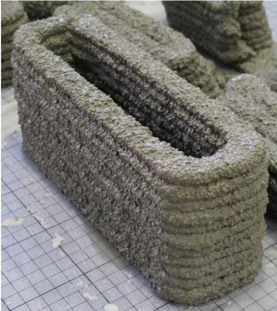
Abbildung 53: Hohlkastenprofil aus extrudiertem Leichtbeton, hier aus einem Leichtbeton mit der Gesteinskörnung Blähglas Liaver, Körnung 1 - 2 mm
