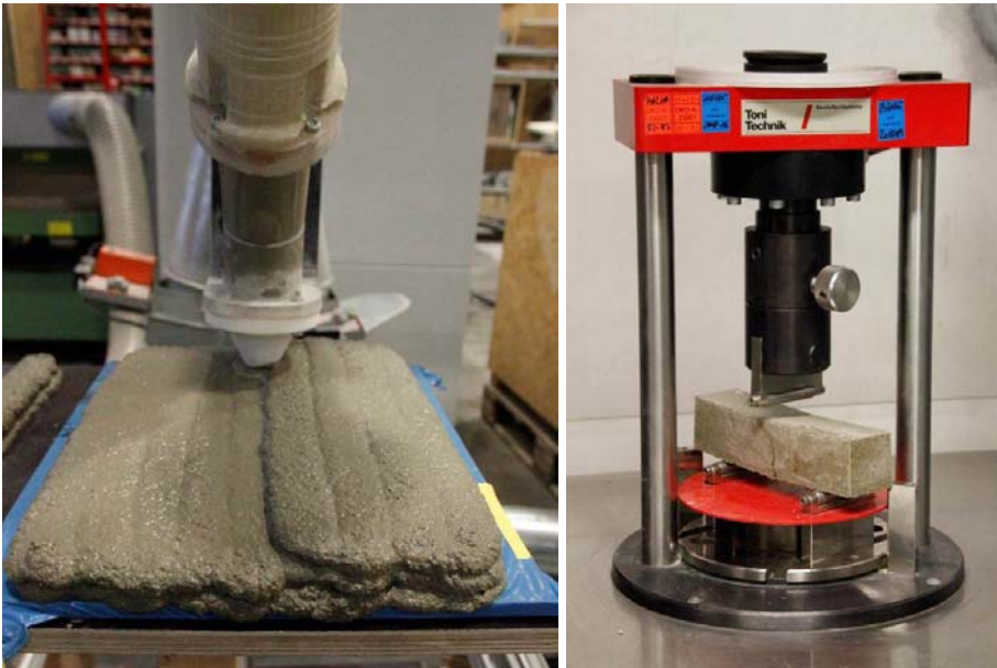
Abbildung 65: Drucken der Platten für die Herstellung von Prüfprismen (links) und Biegezugprüfung (rechts) (Fotos: C. Martius)
