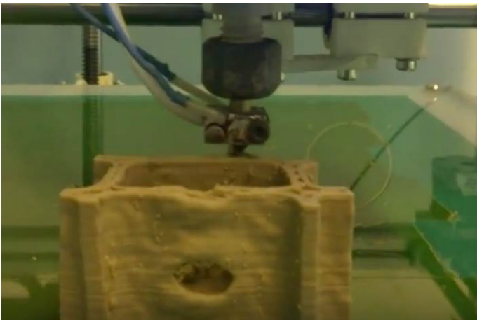
Abbildung 32: Vergrößerte Reproduktion der Zellstruktur von Kiefernholz durch Fused Filament Fabrication mit einem holzbasierten Filament (BOKU 2016)
