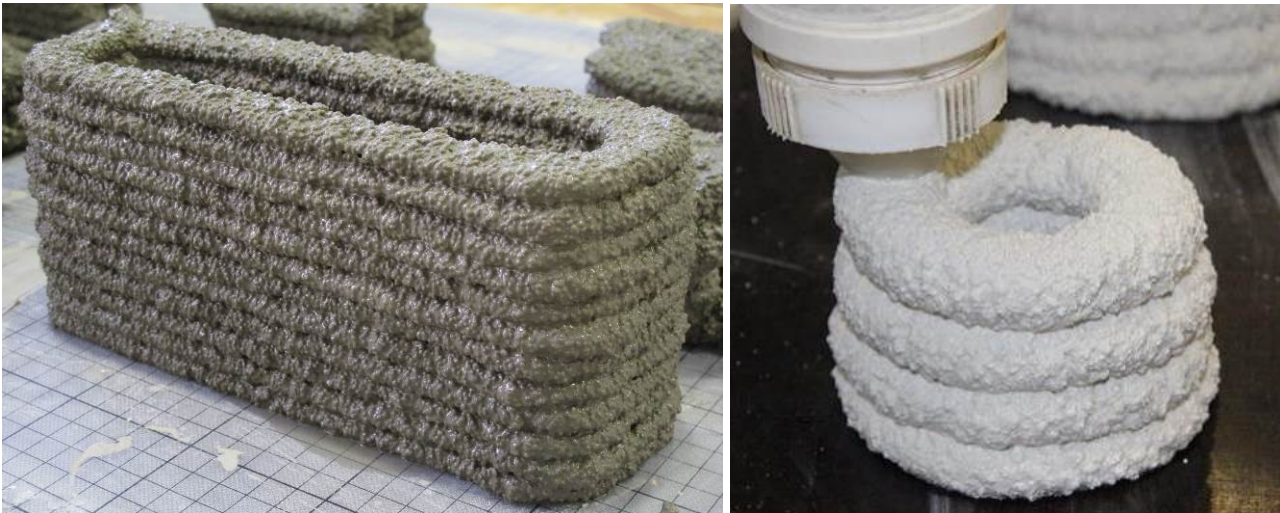
Abbildung 97: Versuche zur Extrusion von Leichtbeton, erste orientierende Versuche (links) und Testobjekt aus Martius (2015) (Mischung 4 in Abbildung 61) (rechts)
