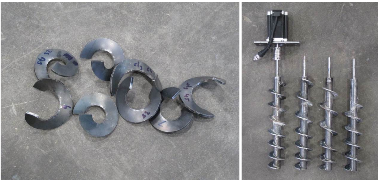
Abbildung 43: Auf Maß gefertigte Schneckenflügel (links) und fertig geschweißte Förderschnecken (von links nach rechts) b (mit Motor), c, d und i (rechts)
