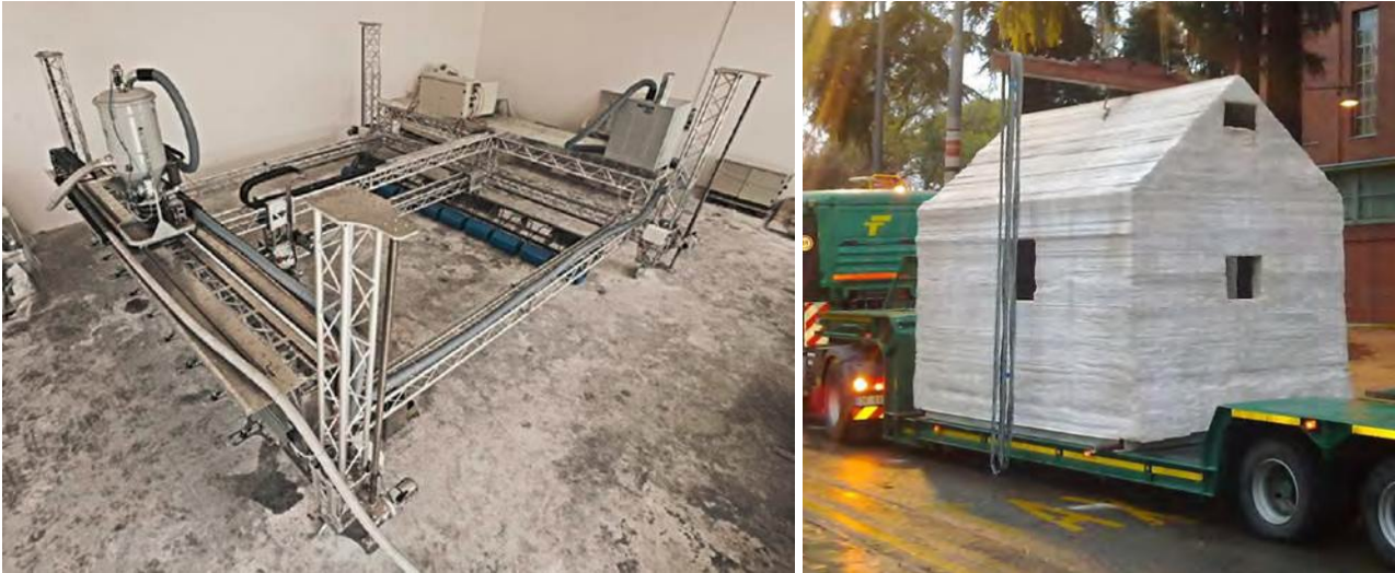
Abbildung 18: D-Shape: Großraum-3D-Drucker (links) und mit dem Drucker hergestellte Casa Ferreri für die Triennale di Milano 2010 (rechts) (Cesaretti et al. 2014)
