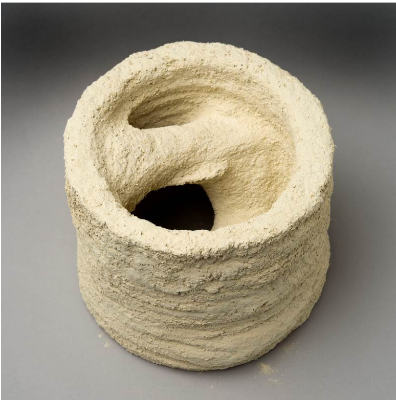
Abbildung 104: Durch selektives Binden von Holzspänen mit Zement hergestelltes Demonstrationsobjekt ‚Rohr mit inneren Verstrebungen‘ (Modellbau Medele 2014, Foto R. Rosin, HFM)
