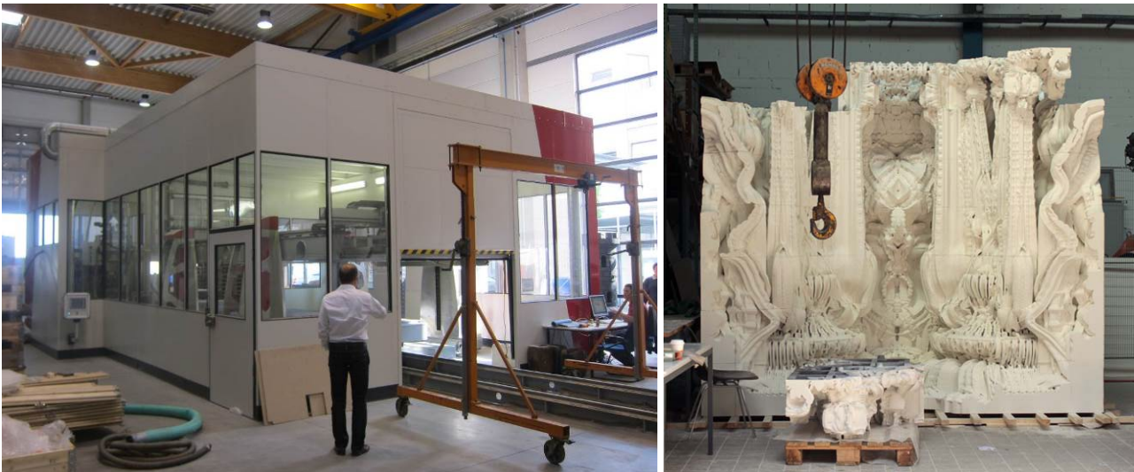
Abbildung 21: Voxeljet: Industrieller 3D-Drucker VX4000 in seiner Einhausung im Werk der voxeljet AG (links, Foto Autor). Und durch 3D-Sanddruck auf der Voxeljet VX4000 hergestelltes Objekt ‚Digital Grotesque‘ (hier noch unvollständig) von Michael Hansmeyer und Benjamin Dillenburger (rechts) (Hansmeyer & Dillenburger 2016).
