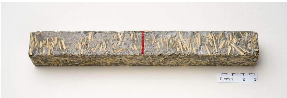
Abbildung 95: Prüfkörper mit quer zur Längsachse des Prüfkörpers ausgerichteten Spänen (Modelle aus Li 2013, Fotos R. Rosin, HFM)
