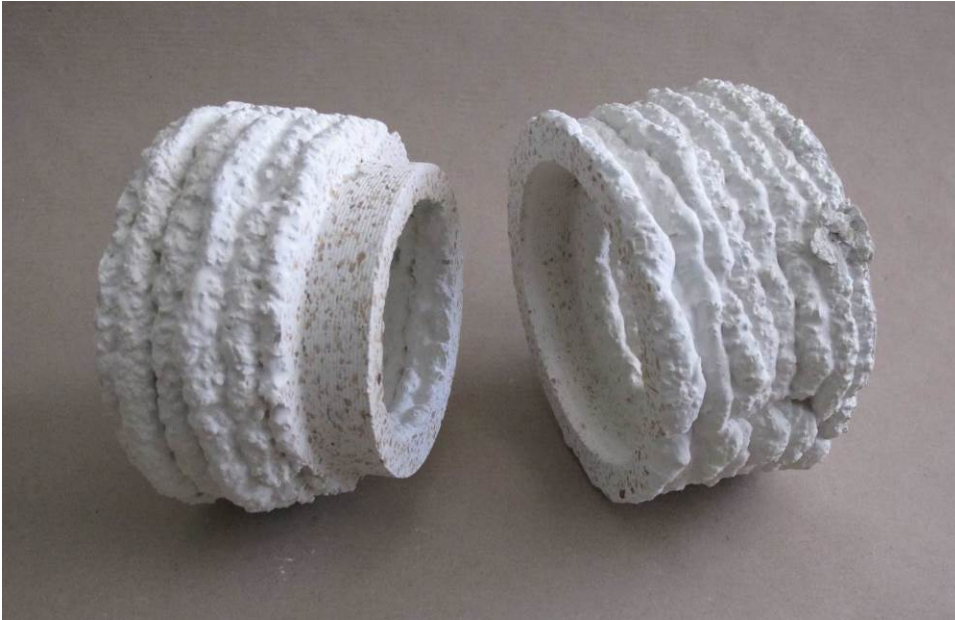
Abbildung 91: Durch Extrusion additiv gefertigtes und mittels Fräsen partiell subtraktiv nachbearbeitetes Bauteil aus Holzleichtbeton (WUTZ Spezialzement für Holzbeton und Buchenspäne Lignocel HB 500-1000), Extrusion und Fräsen erfolgten beide auf dem BZT PF 1000-P Portalsystem (Modell aus Stanglmayr 2015)
