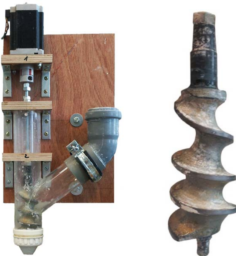
Abbildung 41: Extruder II (links) und im Extruder II eingesetzte Förderschnecke aus einem Fleischwolf (rechts) (Talke 2014)
