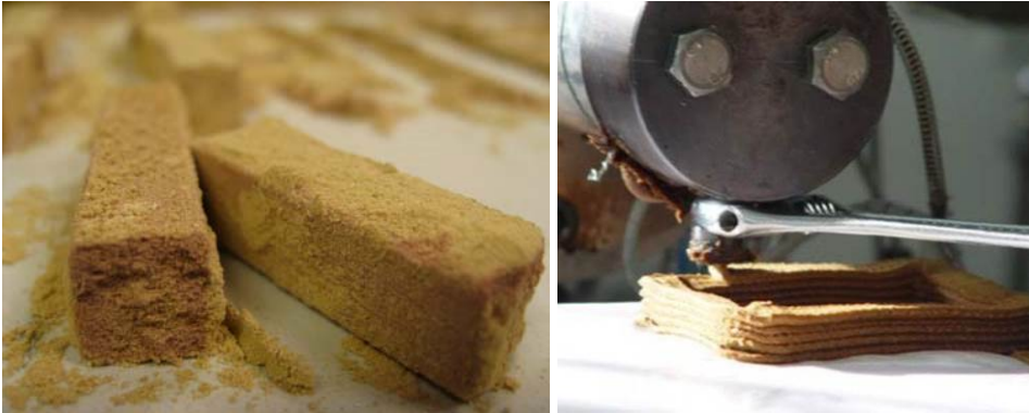
Abbildung 31: Additive Fertigung unter Einsatz von Schüttungen aus Holzpartikeln: selektives Binden von Holzmehl (links) (Trainor 2011) und Extrudieren von WPC (rechts) (Zhao 2011)
