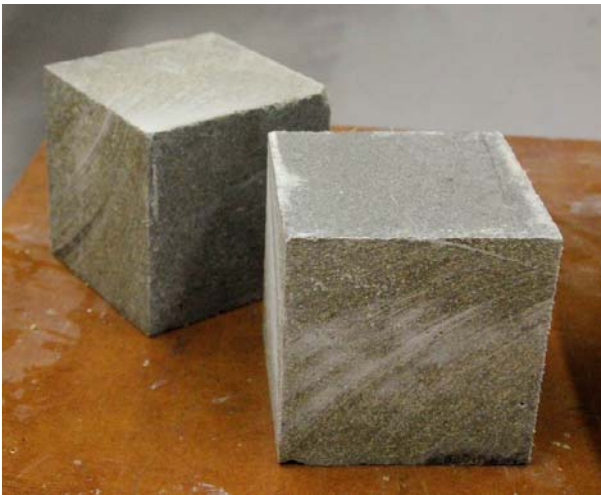
Abbildung 63: Gedruckte und auf Maß geschnittene Probekörper für die Prüfung der Druckfestigkeit (Foto: C. Martius)
