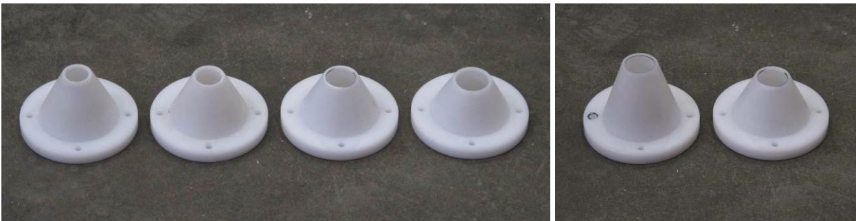
Abbildung 47: Düsen mit gleicher Flankenneigung (20°) und unterschiedlichem Öffnungsdurchmesser (17,5 mm, 20 mm, 22,5 mm und 25 mm) (links) und Düsen mit gleichem Öffnungsdurchmesser (22,5 mm) und unterschiedlicher Flankenneigung (15° und 20°) (rechts)
