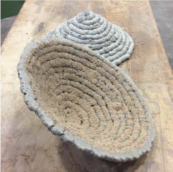
Abbildung 90: Modelle von Kuppelstrukturen, hergestellt durch Ablegen von Holzleichtbetonsträngen auf kegelförmige Partikelschüttungen, beim Modell vorne im Bild diente Sand als Stützmaterial, beim hinteren waren es mineralisierte Späne (Modelle aus Hackl 2016)
