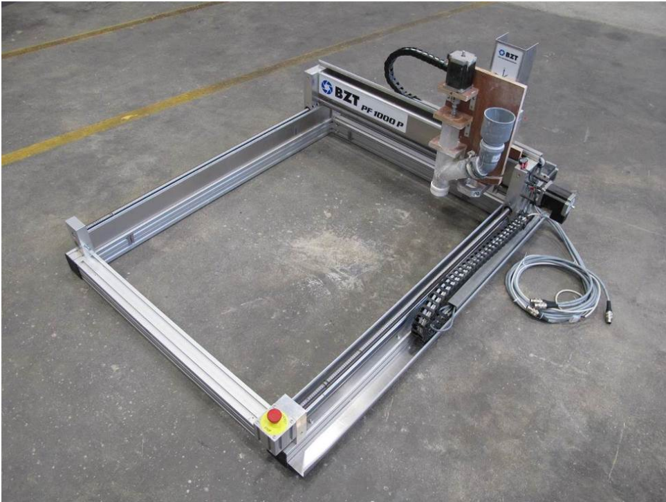
Abbildung 51: CNC-Portalfräse BZT PF 1000-P mit montiertem Extruder II
