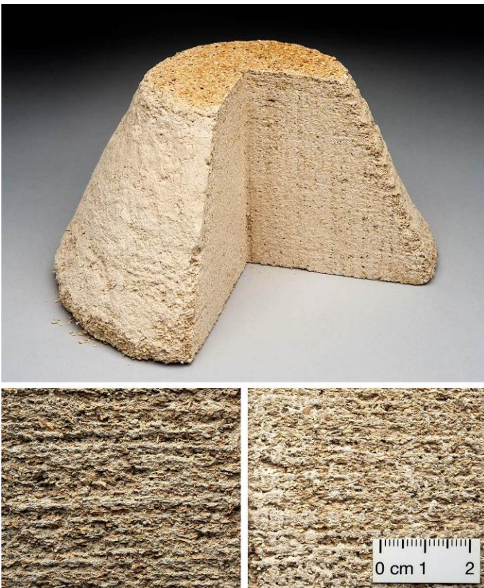
Abbildung 98: Kegelstumpf hergestellt durch selektives Binden von Fichtenspänen mit Gips, aufgeschnitten, um die innere Struktur zu zeigen (oben); innere Struktur eines Probekörpers mit Zement als Bindemittel (unten links); innere Struktur eines Probekörpers mit Gips als Bindemittel (unten rechts) (Henke & Treml 2012)
