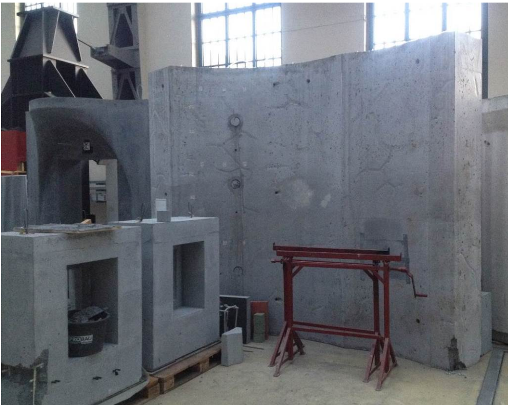
Abbildung 96: Testobjekte aus in Schalung gegossenem Infraleichtbeton in den Prüfhallen der Technischen Universität Berlin, ein großes Wandelement auf einer mehrfach konkav gekrümmten Grundfläche und, links hinten im Bild, ein Wandelement mit räumlich gekrümmten Oberflächen und auskragender Balkonplatte
