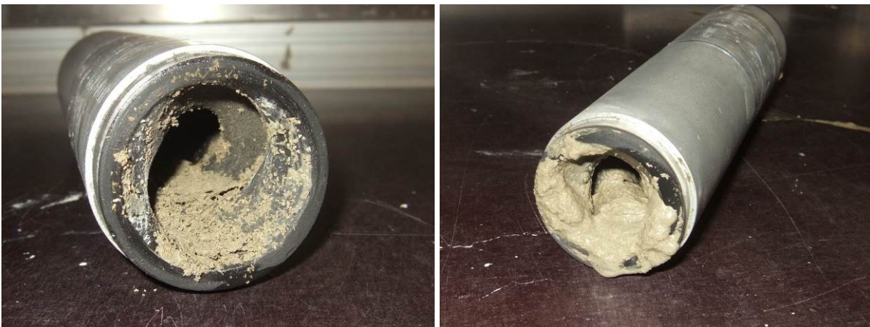
Abbildung 71: Stator des ViscoTec Dispenser 3VMP22 nach dem Versuch mit Arbocel C320 und SCHWENK Portlandkalksteinzement. Entwässerter Spanrückstand an der Saugseite (links) und spanreduzierter Frischbeton an der Druckseite (rechts) (Bauer 2015).
