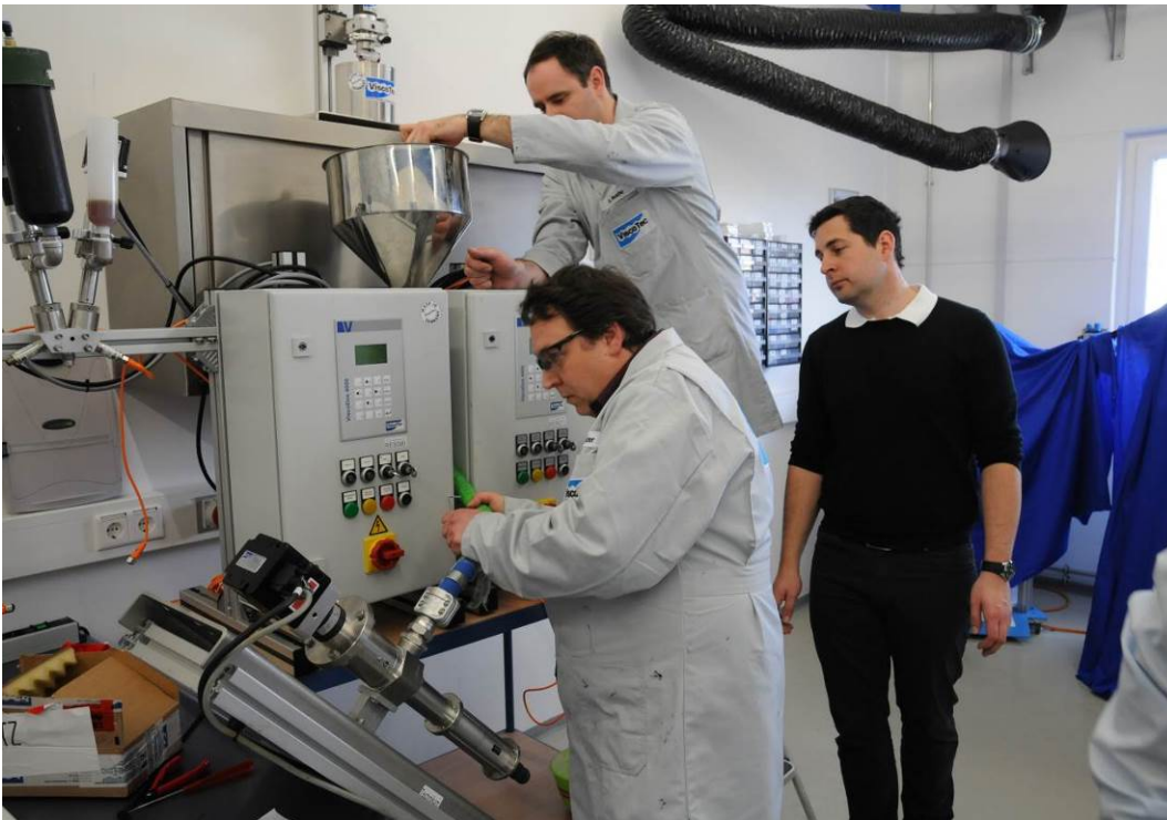
Abbildung 69: Versuche mit Exzentrerschneckenpumpe ViscoTec Dispenser 3VMP22 im Technikum der ViscoTec Pumpen- u. Dosiertechnik GmbH
