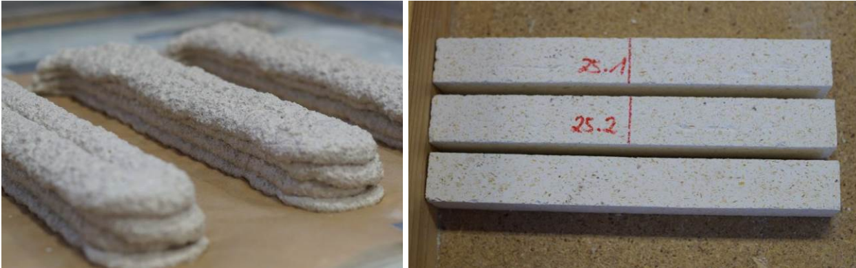
Abbildung 57: Probekörper für Biegezugversuche aus WUTZ Spezialzement für Holzbeton und Buchenspänen Lignocel HB 500-1000, gedruckte Rohlinge (links) und zugeschnittene Probekörper (rechts) (Strobel 2015)
