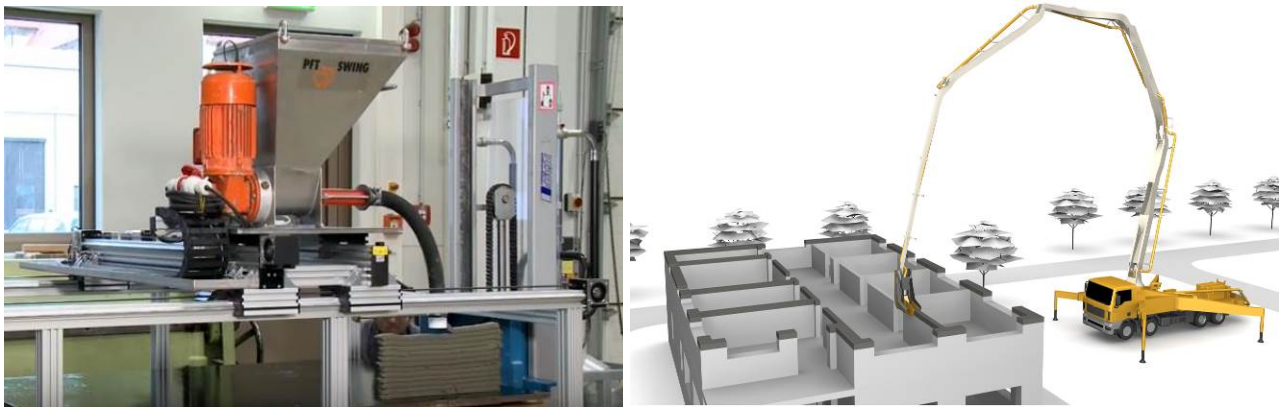
Abbildung 25: CONPrint3D: Versuche mit schnellhärtendem Extrusionsbeton (links) (bftTUD 2016) und digitales Modell mit Autobetonpumpe als Manipulator für Betonextrusion (rechts) (TU Dresden 2016b)
