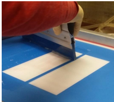
Abbildung 55: Belegung der PC-Platten mit modifiziertem Jeffamine® ED-2003 mit Hilfe eines Siebdruckers.
