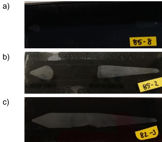
Abbildung 31: Bilder verschiedener Mikroarray-Chips nach unterschiedlichen Lagerbedingungen und -zeiten: a) 1 % BSA mit Zugabe von 0,01 % \text{NaN}_3 in PBS, 4 °C, 4 Wochen, b) 1 % BSA mit Zugabe von 0,01 % \text{NaN}_3 in PBS, 4 °C, 3 Monate, c) 0,125 M Sorbitol mit Zugabe von 0,01 % \text{NaN}_3 in PBS, RT, 6 Monate.
