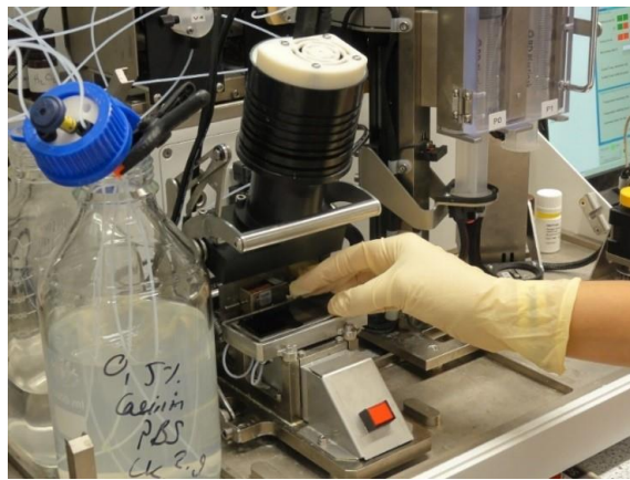
Abbildung 54: Einlegen des Mikroarray-Chips in die Mikroarray-Einheit.
