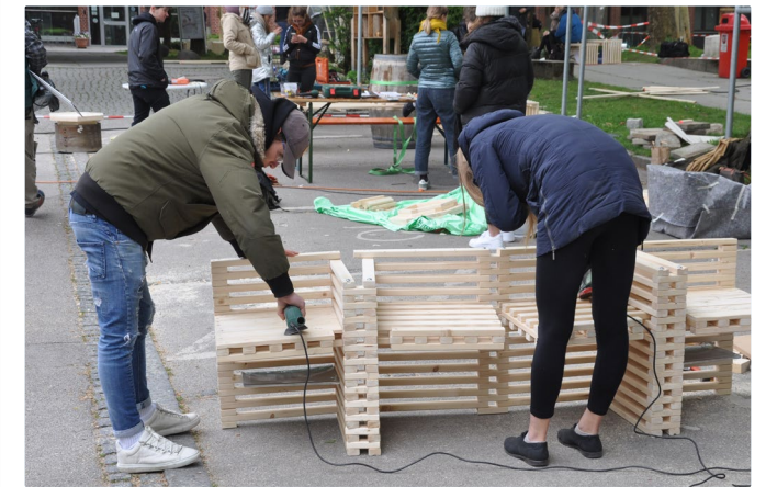
Gewindestangen in den Fügepunkten der einzelnen Sitzelemente ermöglichen unterschiedliche Aufstellmöglichkeiten.
