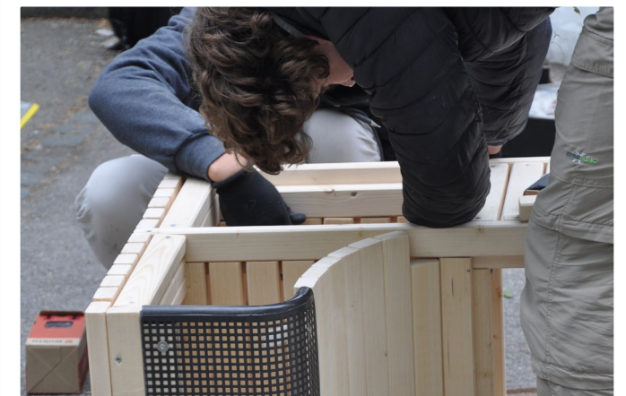
Die Anordnung und Befestigung der Holzlaten, die die Rückenlehne des Sitzelements bilden, nimmt die gebogene Form des Rezyklats auf.
