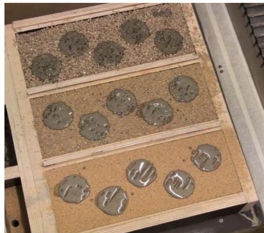
Abbildung 58: Druck von Kreisflächen mit einem Soll-Durchmesser von 50 mm
