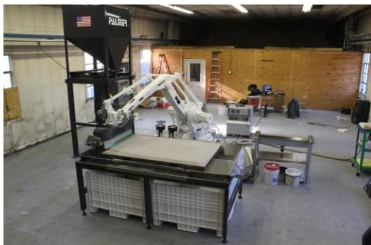
Abbildung 30: Industrieroboter zur additiven Fertigung mittels selektiven Bindens<sup>95</sup>
