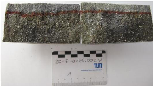
Abbildung 135: Mittels SPI (90°) hergestellte RCM Probekörper
