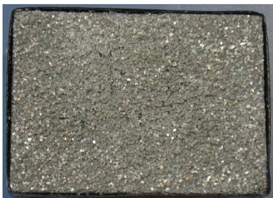
Abbildung 132: Prüffläche eines mittels 3DP-90° hergestellten CDF Probekörpers nach 28 FTW
