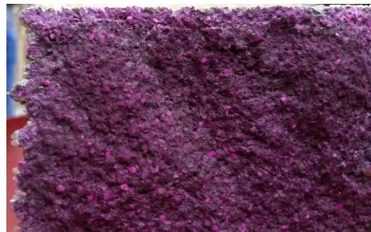
Abbildung 133: Karbonatisierungsprüfung: Detail eines 3DP Probekörpers nach 28 d Lagerung in 2 Vol.-%  $\text{CO}_2$ , Bruchfläche besprüht mit Phenolphthalein
