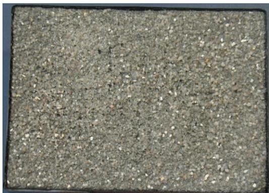
Abbildung 131: Prüffläche eines mittels 3DP-90° hergestellten CDF Probekörpers vor Frosteinwirkung
