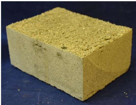
Abbildung 126: Zurechtgesägter 3DP-90° Probekörper für CIF / CDF Test. Die Oberseite zeigt die unbehandelte Prüffläche
