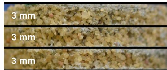
Abbildung 61: Vorarbeit: Leim kann zwar in die Schichten (3 mm) eindringen, diese jedoch nicht ganz durchdringen, da der Fließwiderstand der Gesteinskörnung zu groß ist, Leim CEM I 42,5 R w/z-Wert 0,4, AFM = 300 mm, Gesteinskörnung: Sand B,  $d_{50} = 0,5$  mm, trocken<sup>135</sup>
