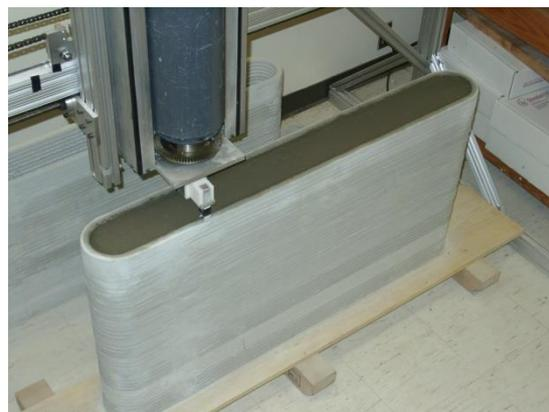
Abbildung 16: Wandelement hergestellt mit Contour Crafting<sup>37</sup>
