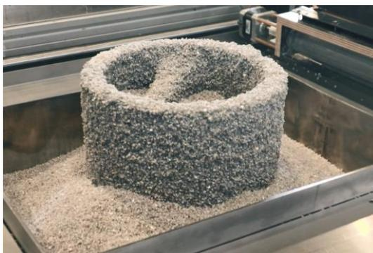
Abbildung 7: Produktionsprozess SPI, fertiges Bauteil im Partikelbett<sup>16</sup>
