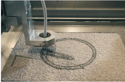
Abbildung 2: Produktionsprozess SPI, lokaler Zementleimauftrag<sup>13</sup>
