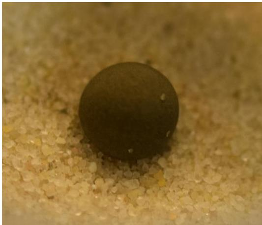
Abbildung 60: Bild aus Vorversuchen, Zementleimtropfen, der aufgrund der Abhängigkeit zwischen Zementleimrheologie und des Fließwiderstandes der Gesteinskörnungsschicht nicht in das Partikelbett eindringen kann, Leim CEM I 42,5 R, w/z-Wert 0,5, AFM = 400 mm, , Gesteinskörnung: Sand A,  $d_{50} = 0,3$  mm, trocken, Tropfendurchmesser ~5 mm
