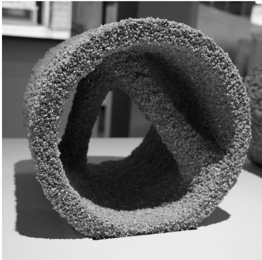
Abbildung 3: Mit SPI hergestelltes Rohr mit innerer Doppelverstrebung ( $d_{50} = 1,6$  mm)
