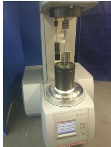
Abbildung 50: Rheometer mit eingebauter Vane-Flügelzelle
