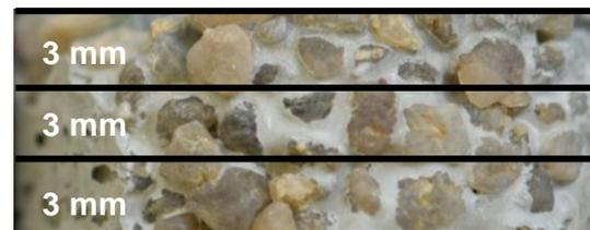
Abbildung 62: Vorarbeit: Leim kann die Schichten (3 mm) völlig durchdringen, der Fließwiderstand der Gesteinskörnung ist klein genug, Leim CEM I 42,5 R, w/z-Wert 0,4, AFM = 300 mm, Gesteinskörnung: Sand B,  $d_{50} = 2,4$  mm, trocken<sup>136</sup>
