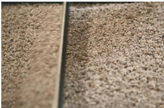
Abbildung 6: Produktionsprozess SPI, Auftrag einer neuen Gesteinskörnungsschicht auf das Partikelbett<sup>15</sup>
