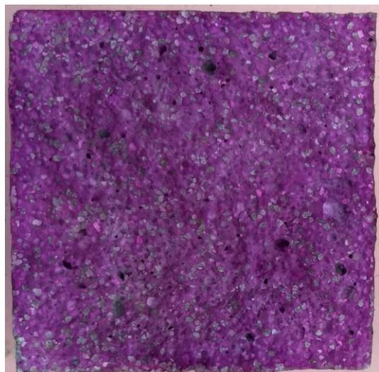
Abbildung 134: Karbonatisierungsprüfung: Referenzprobekörper nach 182 d, Bruchfläche besprüht mit Phenolphthalein
