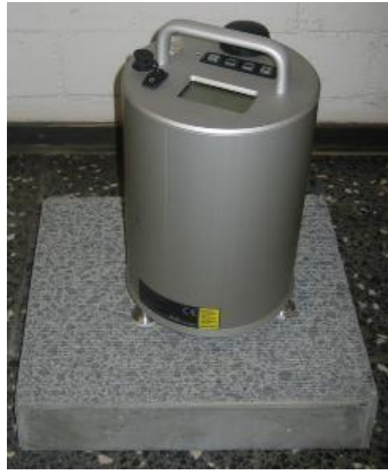
Abbildung 12: Messgerät ELAtextur zur Bestimmung der Texturtiefe
