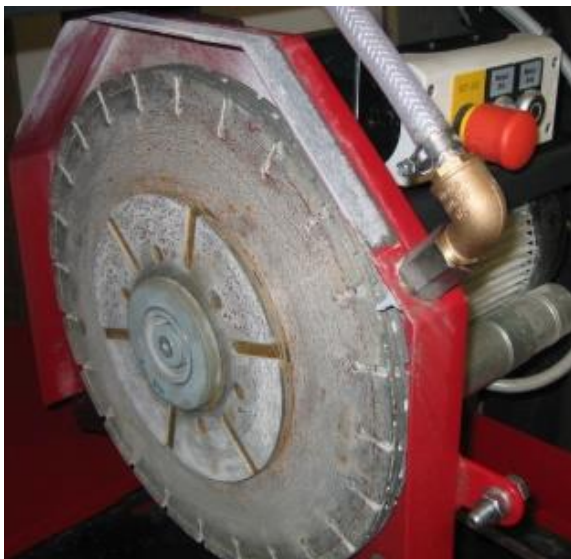
Abbildung 26: Laborgrindingmaschine (oben), Sägeblattanordnung (unten)
