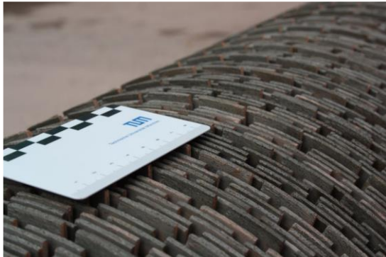
Abbildung 5: Grindingwelle (oben), Nahaufnahme der Sägeblätter (unten)
