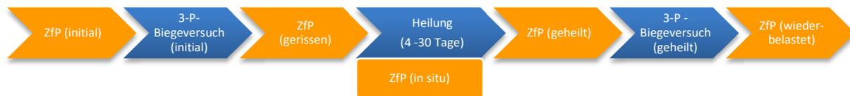
Abbildung 5-2: Flussdiagramm zur Darstellung des Versuchablaufs zur Evaluierung der Heilungseffizienz von Mörtelprismen mit Selbstheilungseigenschaften.
