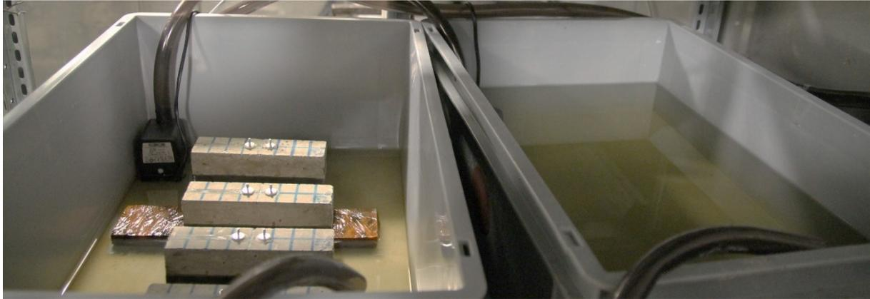
Abbildung 5-10: Versuchsaufbau für Nass-Trockenzyklus für Mörteltestkörper mit Liapor-Ton-Kugeln sowie Hydrogelgranulat.
