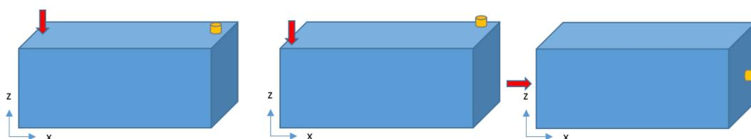
Abbildung 4-8: Position der Impaktanregung (rot) und Beschleunigungsaufnehmer (gelb) für unterschiedliche Schwingungsmodi (von links nach rechts: flexural, torsional, longitudinal) im freien Zustand.
