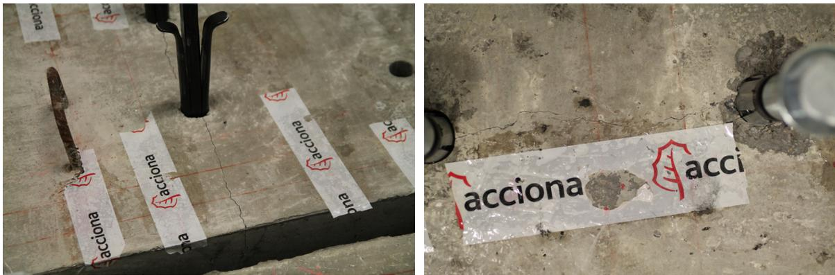
Abbildung 7-8: Bewehrungs- und Rissinitiierungskonzept für Betonplatten. Die spezielle Bewehrungsanordnung ermöglichte mittels Einschlagkeile und Schwerlastanker eine gezielte Rissöffnung mit anschließender Stabilisierung.
