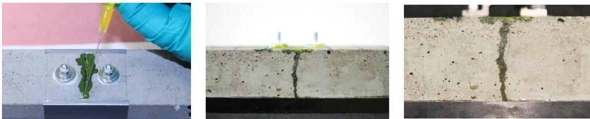
Abbildung 5-4: Links: Manuelle Verfüllung des Risses mit niedrigviskosem Polyurethan (angereichert mit fluorisierenden Pigmenten). Mitte: Ausgehärtetes Heilmittel nach 4 Tagen (Bild zeigt „SLV II“). Rechts: Bildung neuartiger Rissstrukturen nach Heilung und anschließender Wiederbelastung (Bild zeigt „SLV II“).
