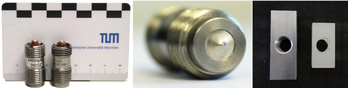
Abbildung 4-10: Ultraschall KRNB-PC Sensor mit individuell gefertigter Halterung aus Aluminium und PVC.
