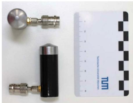
Abbildung 4-16: UPE/G-Sensoren der Firma Geotron Elektronik (Bild aus [Moser 2014])
