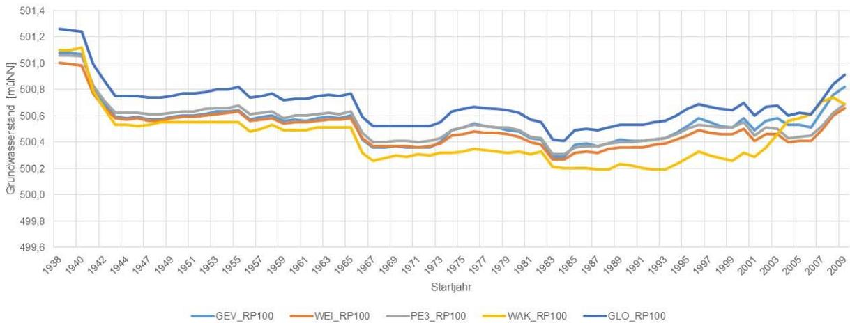
**Abb. 16:** Entwicklung des Grundwasserstands HW100 bei Auswertung mittels BM für die Grundwasser-
