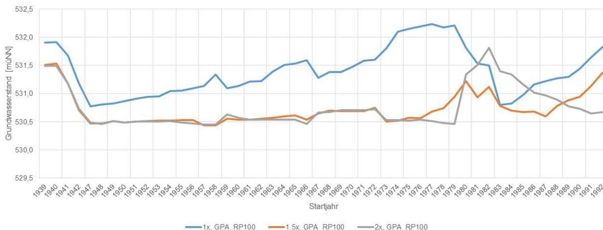
**Abb. 62:** Entwicklung des Grundwasserstands HW100 bei Auswertung mittels POT und unter Berücksichtigung der Grundwasserstände HW1940 und HW1979 für die Grundwassermessstelle Pöring 266A
