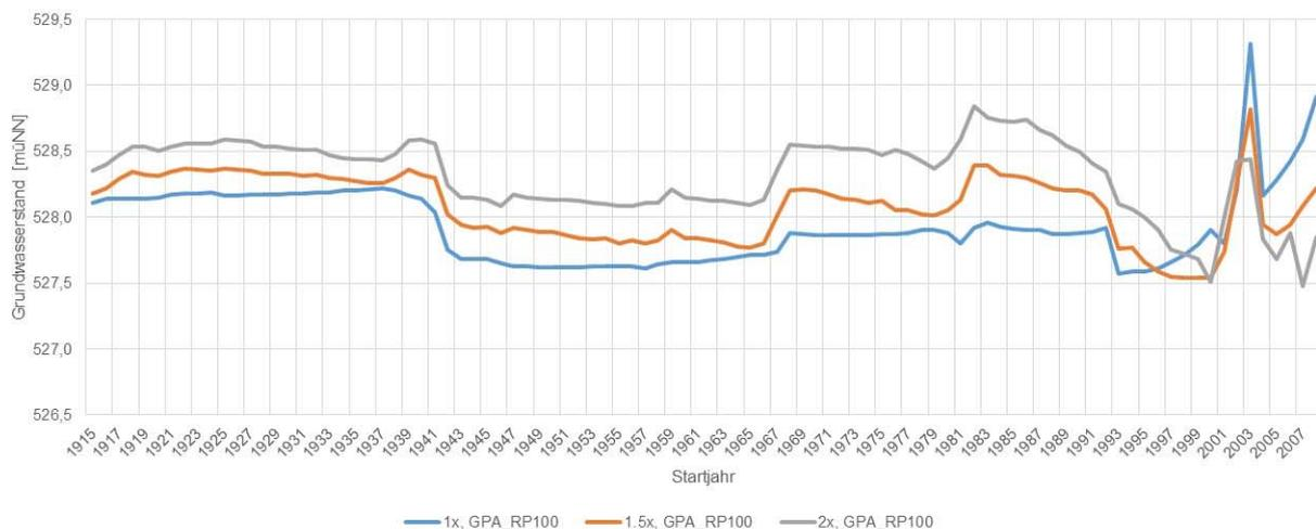
**Abb. 50:** Entwicklung des Grundwasserstands HW100 bei Auswertung mittels POT und unter Berücksichtigung des Grundwasserstands HW1940 für die Grundwassermessstelle Eglfing Lehrer 265B
