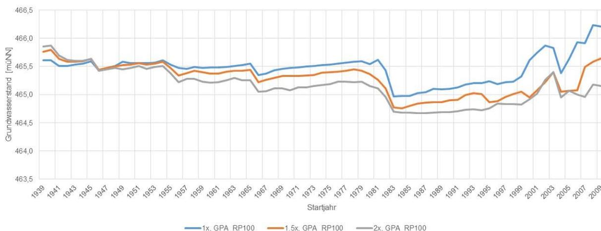
**Abb. 49:** Entwicklung des Grundwasserstands HW100 bei Auswertung mittels POT und unter Berücksichtigung des Grundwasserstands HW1940 für die Grundwassermessstelle Eching 275D
