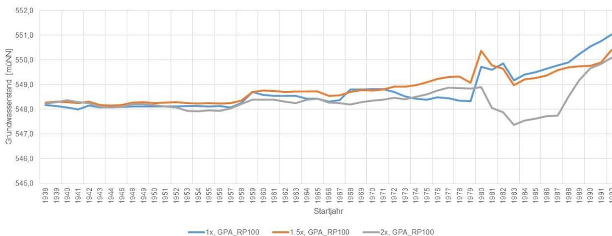
**Abb. 63:** Entwicklung des Grundwasserstands HW100 bei Auswertung mittels POT und unter Berücksichtigung der Grundwasserstände HW1940 und HW1979 für die Grundwassermessstelle Wolfersberg 266
