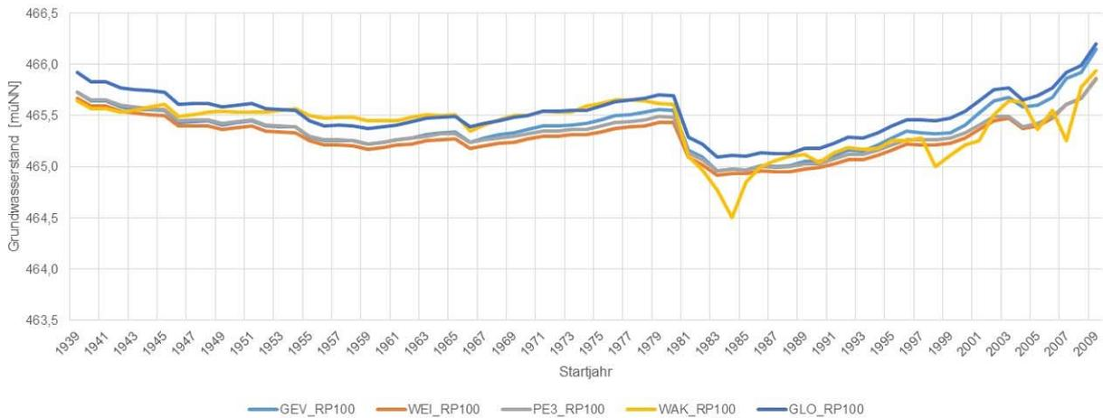
**Abb. 33:** Entwicklung des Grundwasserstands HW100 bei Auswertung mittels BM und unter Berücksichtigung der Grundwasserstände HW1940 und HW1979 für die Grundwassermessstelle Eching 275D
