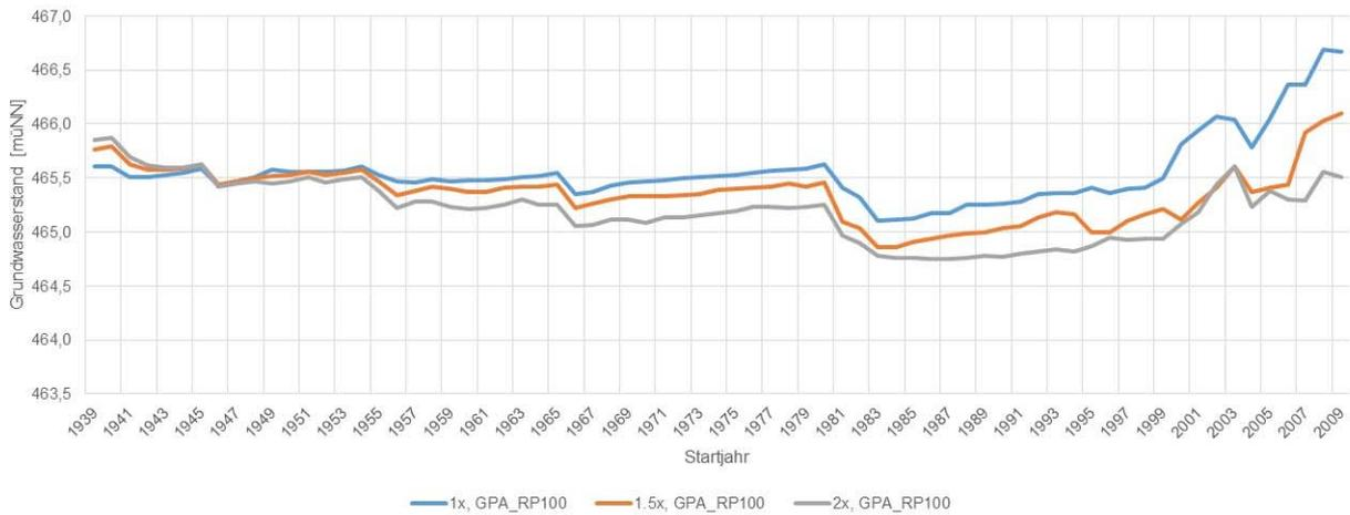
**Abb. 57:** Entwicklung des Grundwasserstands HW100 bei Auswertung mittels POT und unter Berücksichtigung der Grundwasserstände HW1940 und HW1979 für die Grundwassermessstelle Eching 275D
