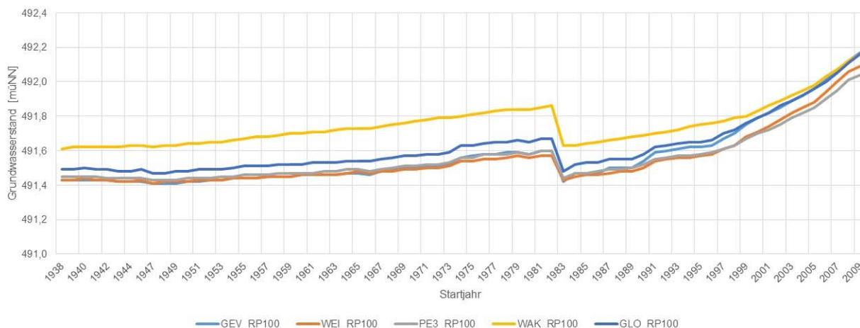
**Abb. 35:** Entwicklung des Grundwasserstands HW100 bei Auswertung mittels BM und unter Berücksichtigung der Grundwasserstände HW1940 und HW1979 für die Grundwassermessstelle Feldmoching 295
