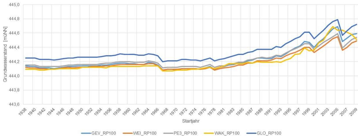
**Abb. 20:** Entwicklung des Grundwasserstands HW100 bei Auswertung mittels BM für die Grundwasser- messstelle Freising 275C
