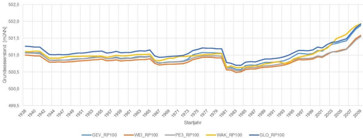
**Abb. 32:** Entwicklung des Grundwasserstands HW100 bei Auswertung mittels BM und unter Berücksichtigung der Grundwasserstände HW1940 und HW1979 für die Grundwassermessstelle Allach 289A
