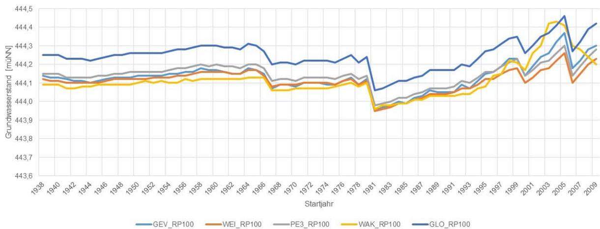
**Abb. 28:** Entwicklung des Grundwasserstands HW100 bei Auswertung mittels BM und unter Berücksichtigung des Grundwasserstands HW1940 für die Grundwassermessstelle Freising 275C
