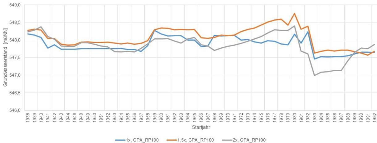
**Abb. 47:** Entwicklung des Grundwasserstands HW100 bei Auswertung mittels POT für die Grundwasser-
