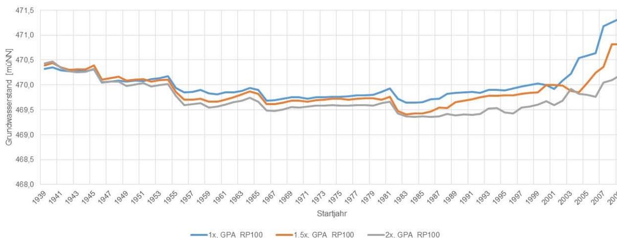
**Abb. 61:** Entwicklung des Grundwasserstands HW100 bei Auswertung mittels POT und unter Berücksichtigung der Grundwasserstände HW1940 und HW1979 für die Grundwassermessstelle Lohhof 275A
