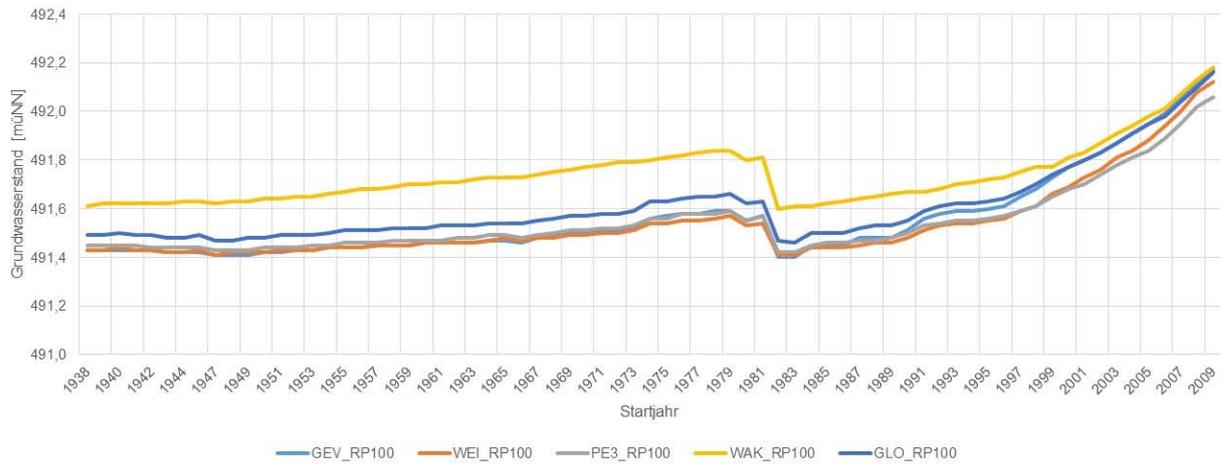
**Abb. 27:** Entwicklung des Grundwasserstands HW100 bei Auswertung mittels BM und unter Berücksichtigung des Grundwasserstands HW1940 für die Grundwassermessstelle Feldmoching 295
