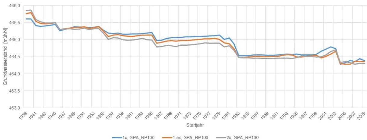
**Abb. 41:** Entwicklung des Grundwasserstands HW100 bei Auswertung mittels POT für die Grundwassermessstelle Eching 275D
