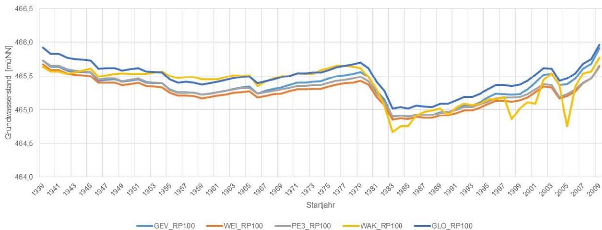
**Abb. 25:** Entwicklung des Grundwasserstands HW100 bei Auswertung mittels BM und unter Berücksichtigung des Grundwasserstands HW1940 für die Grundwassermessstelle Eching 275D
