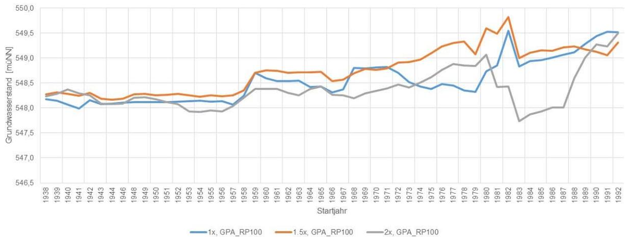
**Abb. 55:** Entwicklung des Grundwasserstands HW100 bei Auswertung mittels POT und unter Berücksichtigung des Grundwasserstands HW1940 für die Grundwassermessstelle Wolfersberg 266
