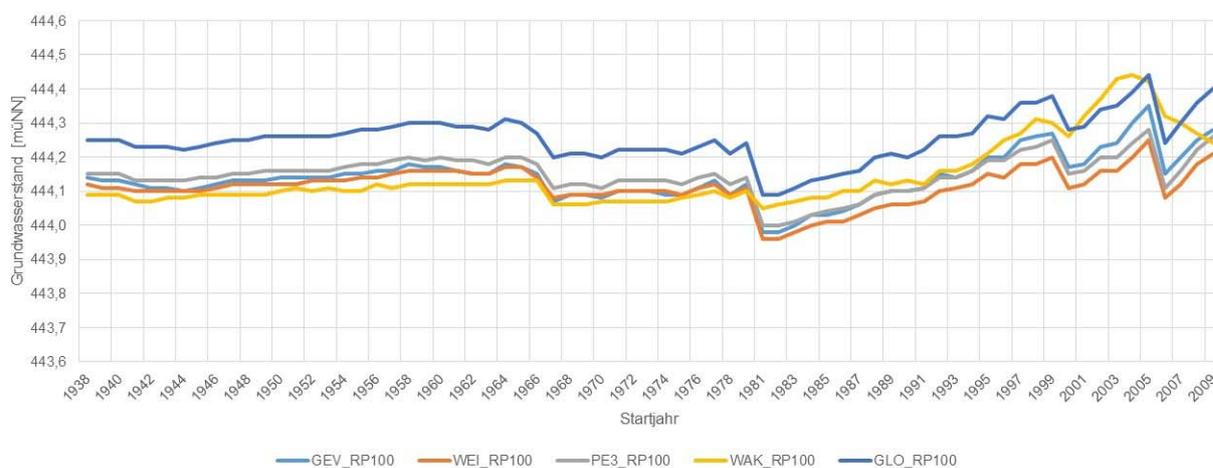
**Abb. 36:** Entwicklung des Grundwasserstands HW100 bei Auswertung mittels BM und unter Berücksichtigung der Grundwasserstände HW1940 und HW1979 für die Grundwassermessstelle Freising 275C
