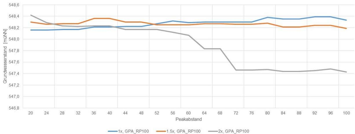
**Abb. 68:** Auswirkung des Mindestpeakabstands auf den Grundwasserstand HW100 bei Auswertung mit POT für die Grundwassermessstelle Wolfersberg 266
