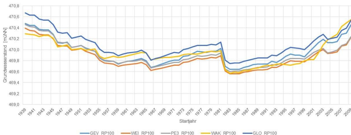
**Abb. 37:** Entwicklung des Grundwasserstands HW100 bei Auswertung mittels BM und unter Berücksichtigung der Grundwasserstände HW1940 und HW1979 für die Grundwassermessstelle Lohhof 275A
