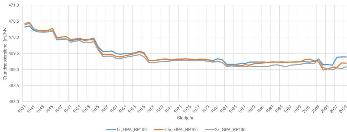
**Abb. 45:** Entwicklung des Grundwasserstands HW100 bei Auswertung mittels POT für die Grundwasser- messstelle Lohhof 275A
