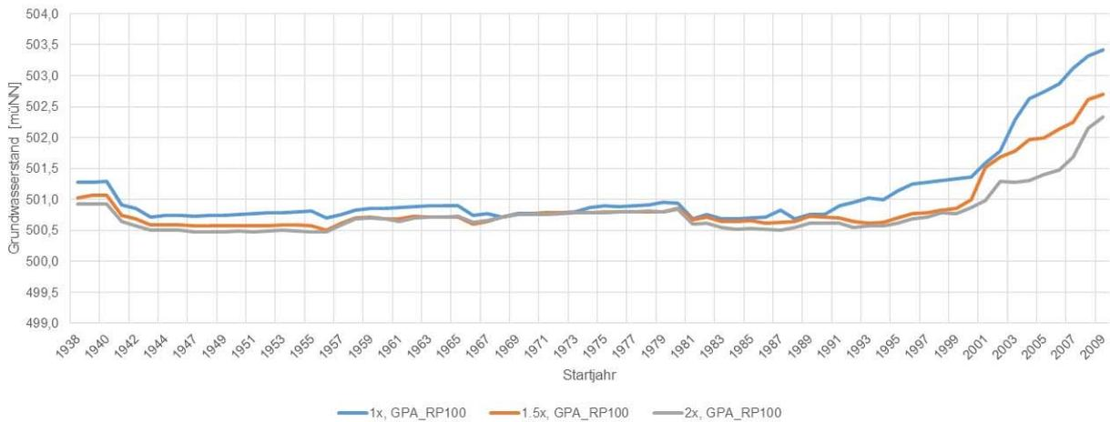
**Abb. 56:** Entwicklung des Grundwasserstands HW100 bei Auswertung mittels POT und unter Berücksichtigung der Grundwasserstände HW1940 und HW1979 für die Grundwassermessstelle Allach 289A
