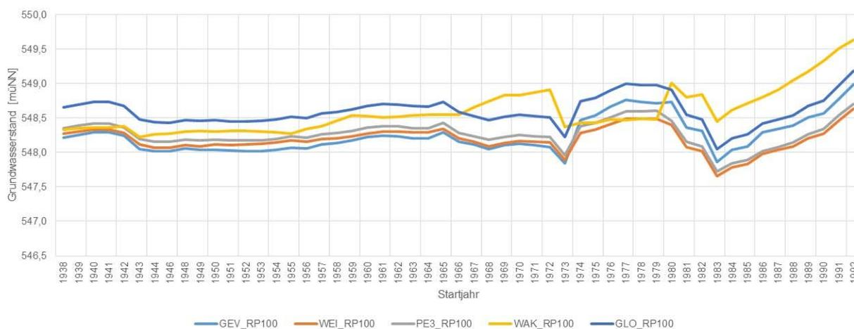
**Abb. 39:** Entwicklung des Grundwasserstands HW100 bei Auswertung mittels BM und unter Berücksichtigung der Grundwasserstände HW1940 und HW1979 für die Grundwassermessstelle Wolfersberg 266
