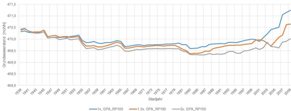
**Abb. 53:** Entwicklung des Grundwasserstands HW100 bei Auswertung mittels POT und unter Berücksichtigung des Grundwasserstands HW1940 für die Grundwassermessstelle Lohhof 275A
