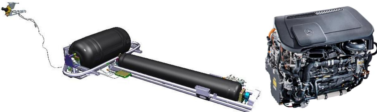
Abbildung 2-18 Aufbau des Wasserstofftankensystems (links) und des Brennstoffzellensystems (rechts) des Brennstoffzellenfahrzeugs Mercedes-Benz GLC F-CELL der Firma Daimler AG [60]
