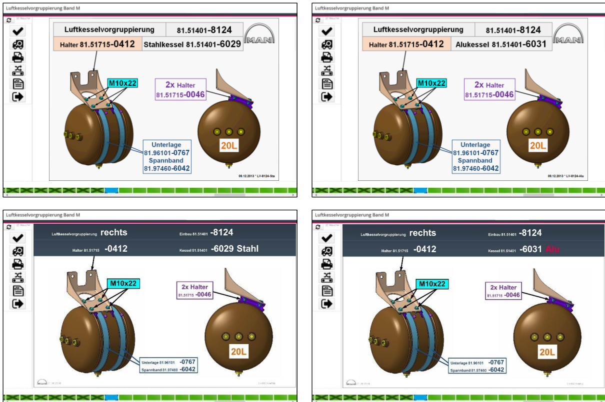
Abbildung 7-8: Webbasierte, MAN-spezifische Werkerinfo-Software für die Luftkesselvordruppierung zum Vergleich der umgestellten Werkerinformationsbilder (oben: vorher; unten: nachher)
