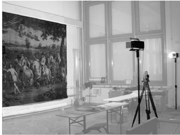
Abbildung 6.3: Versuchsaufbau zur Vermessung der Tapiserie „Der Generalstab“ mit einem Theodolit.
