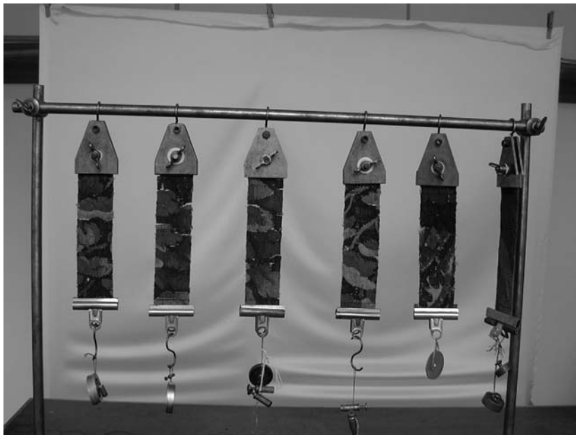
Abbildung 5.5: Der Versuchsaufbau zur Erstellung eines Kraft-Dehnungs-Diagrammes. Gemessen wurde die zeitabhängige Dehnung bei konstanter Kraft und anschließend im entlasteten Zustand die Relaxation.
