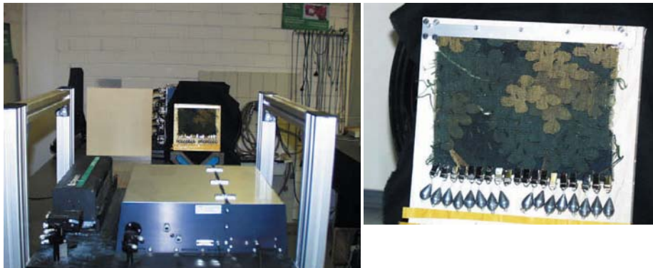
Abbildung 6.23: Links ist der Aufbau bei der Fa. Steinbichler gezeigt. Es handelt sich um ein ESPI System. Als Lichtquelle dient ein Nd:YAG Laser mit 200 mW. Rechts die verwendete Probe (Fotos: Fa. Steinbichler).
