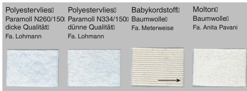
Abbildung 7.2: Die zur Reibungszahl-Bestimmung als Plattenbezugsstoff verwendeten Materialien. Beim Babykord ist die Gleitrichtung durch den Pfeil gekennzeichnet.
