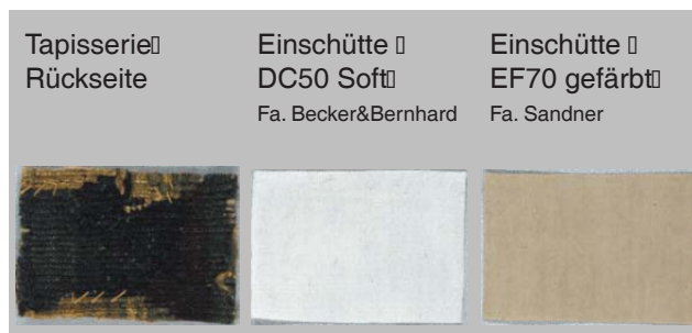
Abbildung 7.3: Die zur Reibungszahl-Bestimmung als Futterstoff verwendeten Materialien. Es wurde auch die Rückseite eines Tapissérie-Fragments geprüft. Die Gleitrichtung entsprach dabei der Schußrichtung (im Bild die senkrechte Richtung).
