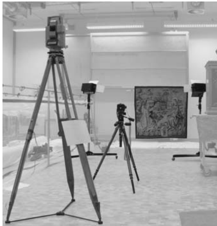
Abbildung 6.4: Versuchsaufbau zur Vermessung der Tapiserie „Hortus Conclusus“ mit einem Theodolit der Fa. Wild.
