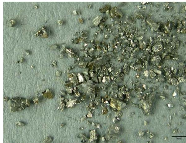
▲ **Abb. 33:** Markasit aus Abbildung 32, im Mörser zerkleinert. Die Markasitpartikel besitzen einen grünlichen metallischen Glanz [Materialsammlung TUM].
