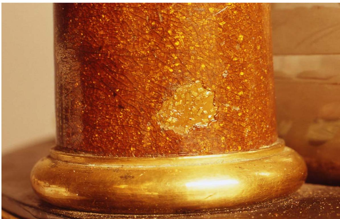
▲Abb. 14: Ausbruchstelle mit fehlendem Lack; die aufgestreuten, rechteckigen Metallschnipsel liegen auf einer gelb-braunen Schicht.
