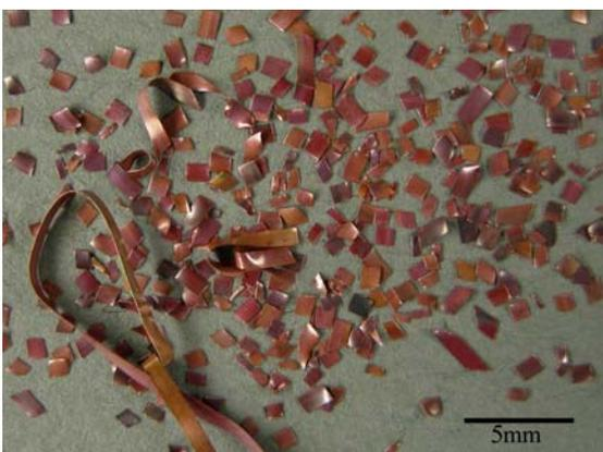
◄ **Abb. 19:** Gewalzter Kupferdraht mit Anlassfarben, nach dem Anlassen mit der Schere geschnitten.
