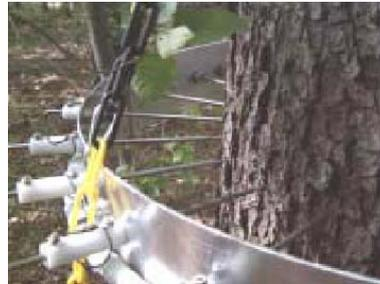
Abb. 4: Nadelelektroden am Baum
