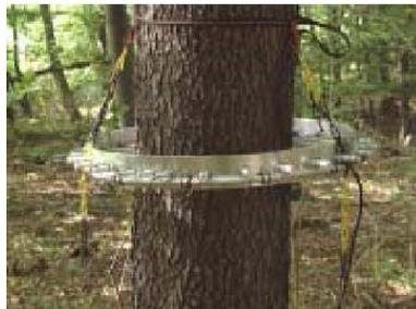
Abb. 3: Elektrodenkonfigurationsring an Elsbeere
