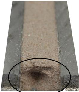
pyramidenförmiger Ausbruch an Stirnseite
