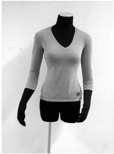
Abb. 9.1: Messaufbau: Das Shirt ist angezogen und in Form gebracht. Der Träger nimmt eine aufrechte, lockere Haltung ein.
