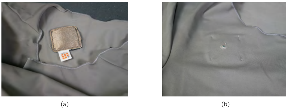
Abb. 8.6: Eine Flächeneinzelelektrode aus versilberter Maschenware ist auf der Innenseite des Shirts angenäht (a). Auf der Außenseite ist der Druckknopf zum Anschluss des Ableitungskabels zugänglich (b).
