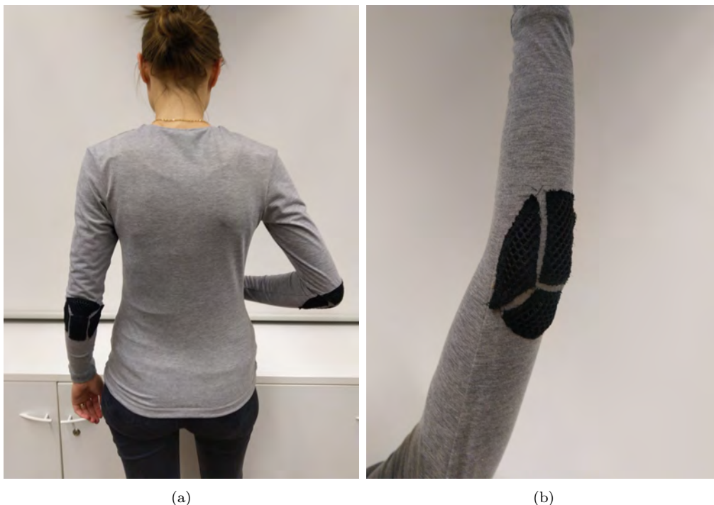
Abb. 8.2: Ellenbogenschutzpolster aus einem 3D-Netzgewebe: Positionierung auf Höhe des Ellenbogengelenks (a) und vierteiliges Design (b), um keine Bewegungseinschränkungen hervorzurufen.
