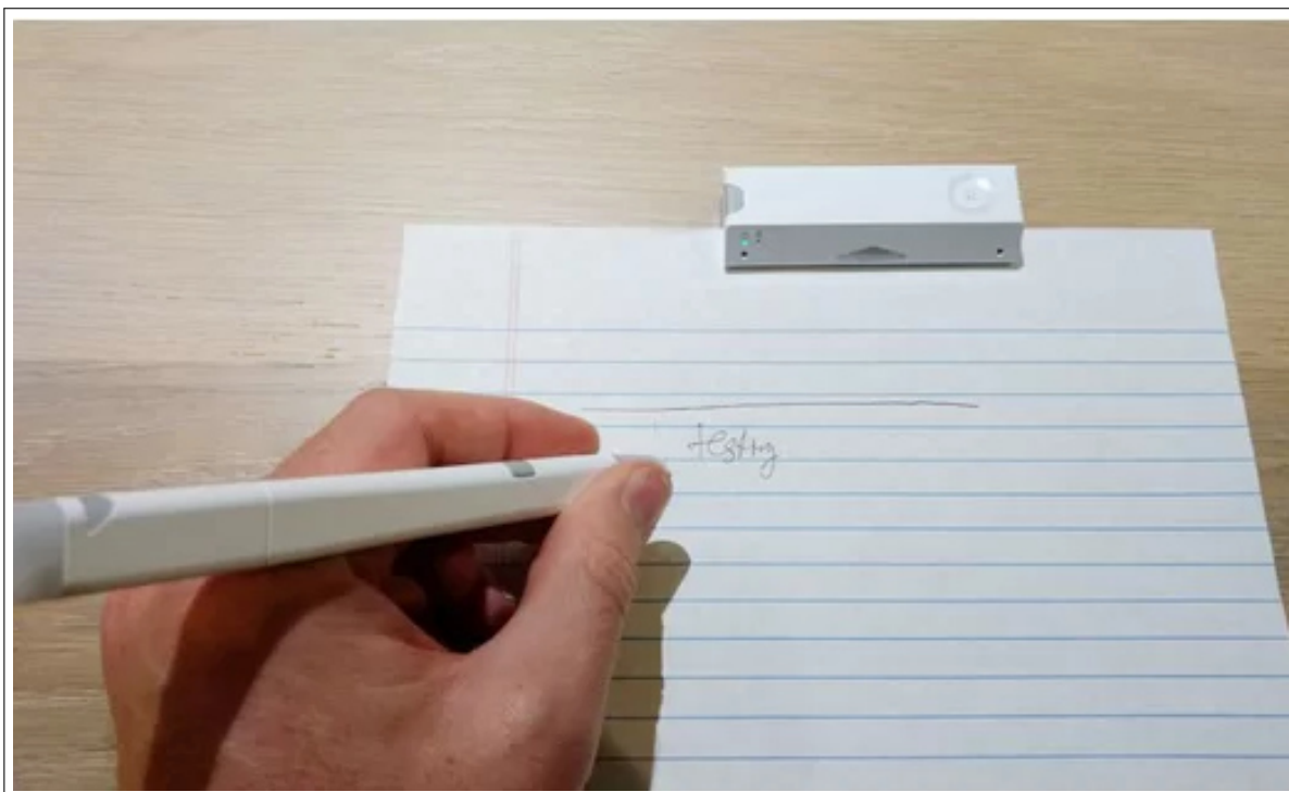
Abbildung 5.3: Digitalstift Smart-Pen 2 von Equil mit Empfänger (Quelle: https://img.purch.com )
