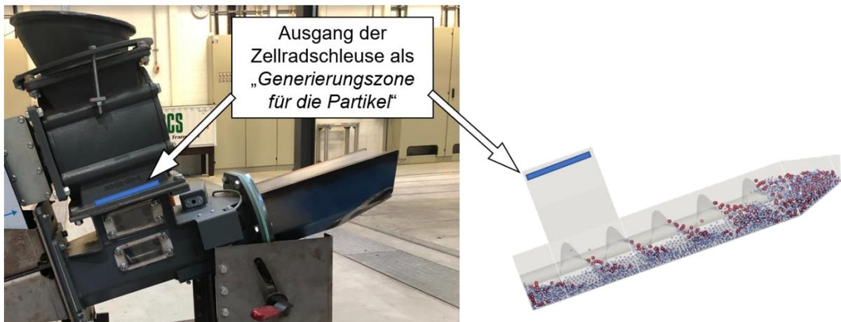
Abbildung 9-1: Maschine (links) und Simulationsmodell (rechts) des dritten Prototyps in der DEM-CFD-Umgebung
