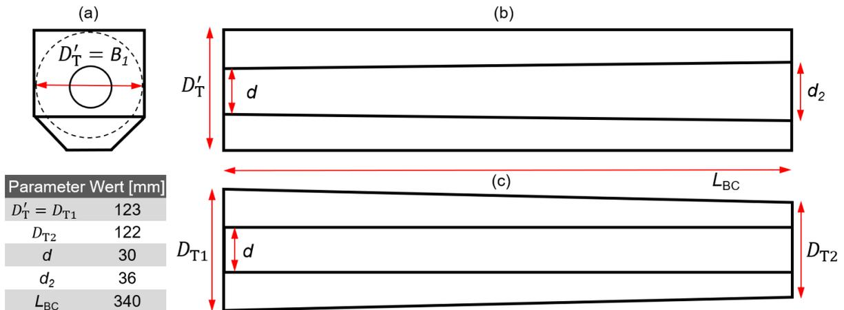
Abbildung 6-13: Skizze des Querschnitts (a) und der verjüngenden Welle vom modifizierten P1 (b); konfigurierter Form von (b): verjüngender Trogquerschnitt zum Einsatz der von Dai vorgestellten Methode [Dai-2008a].
