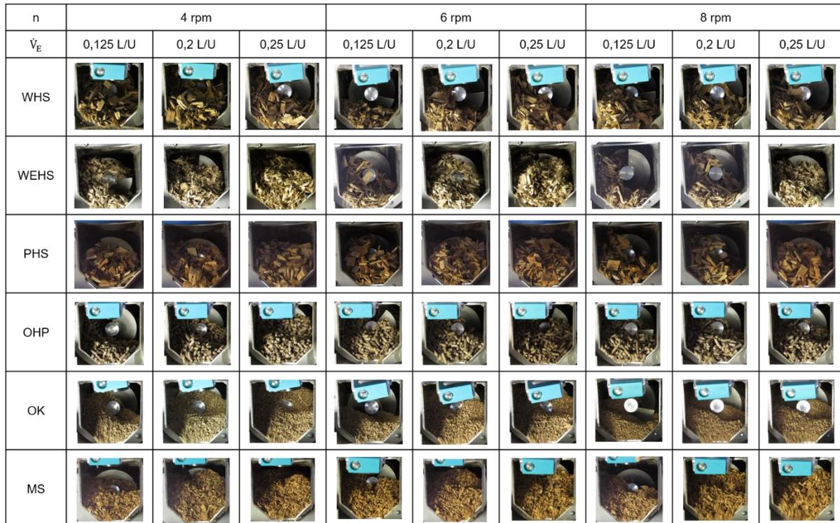
Abbildung B-1: Fotos des Füllstands über variierten Drehzahlen und VaE (WHS, WEHS, PHS, OHP, OK und MS;  $\beta = 15^\circ$ )
