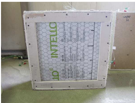
Abbildung A. 3: Versuchskörper V3 einer 60 mm dicken Zelluloseeinblasdämmung geschützt mittels Metallzaun 6 Eck-Geflecht und hinterlegt durch eine 19 mm dicke Spanplatte
