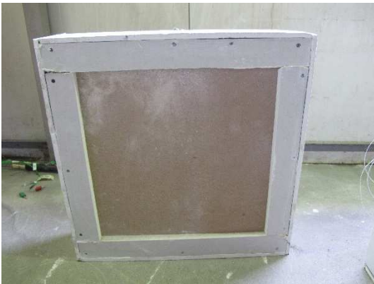
Abbildung A. 6: Versuchskörper V4 einer 60 mm dicken Holzfaserdämmplatte (Typ: Steico Protect Typ M) hinterlegt durch eine 19 mm dicke Spanplatte
