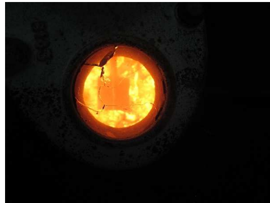
Abbildung A. 7: Versuchskörper V4 nach ca. 54 Minuten unter Brandbeanspruchung gemäß Einheits-Temperaturzeitkurve (ETK)
