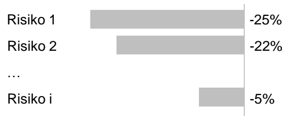
Abbildung 38: Grafische Darstellung der Ergebnisse der Sensitivitätsanalyse in einem Tornado-Diagramm (in Anlehnung an BREDOW 2012, S. 114)
