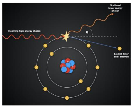
Abbildung 2: Graphische Darstellung des Compton-Effekts [10]
