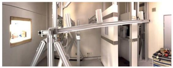
Abbildung 13: Foto des Röntgen-Dunkelfeldradiographie-Systems am Klinikum rechts der Isar
