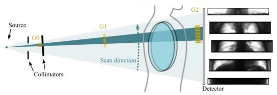
Abbildung 12: Schematische Darstellung des Röntgen-Dunkelfeldradiographie-Systems und beispielhafte Rohbilder. Die drei Gitter (G0, G1, G2) erzeugen ein Intensitätsmuster in der Detektorebene. In einem Scan wird dieses Muster im aktiven Gitterbereich (dunkelblau),
