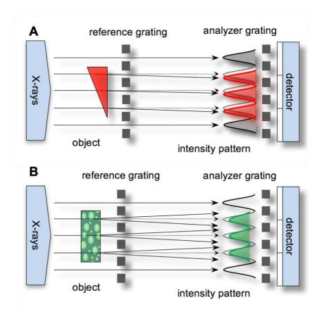
**Abbildung 3:** Graphische Darstellung der Entstehung von Phasen- (A) und Dunkelfeldkontrast (B) – adaptiert von [11]
