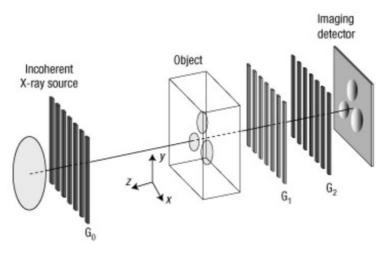
Abbildung 4: Gitteranordnung eines Talbot-Lau-Interferometers - adaptiert von [17]. Die Röntgenstrahlen durchlaufen zunächst G0, wobei individuell kohärente Strahlen erzeugt werden, dann das zu untersuchende Objekt. Nachdem sie das zweite und dritte Gitter G1 und G2 durchlaufen haben, treffen sie auf den Detektor auf.
