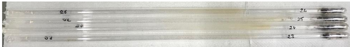
Abbildung 4-9: Ampullen mit einer Länge von 45 cm nach einer Umsetzung mit rotem Phosphor, Zinn und \text{SnBr}_2 im 3-Zonen-Ofen mit einem Temperaturgradienten von 250 °C – 300 °C.
