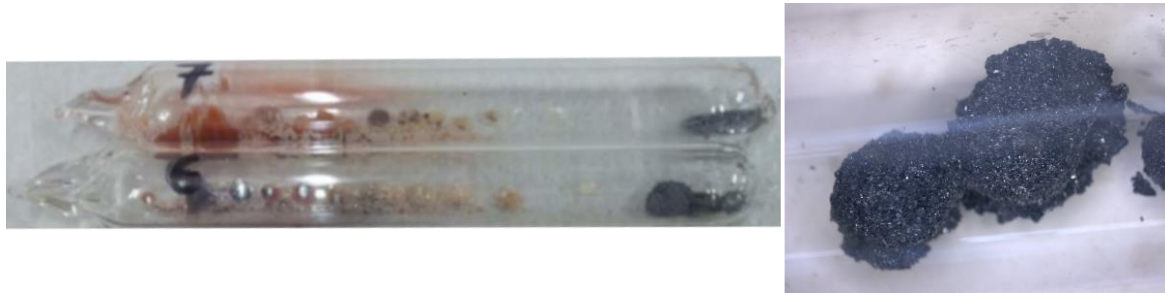
Abbildung 4-2: Links dargestellt sind zwei beispielhafte Ampullen nach einer Synthese bei 400 °C. Rechts ist eine Nahaufnahme der Sn 24 P 19,6 Br 8 und Sn 4 P 3 Kristalle auf der heißen Seite der Ampulle.
