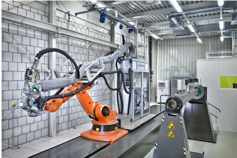
**Abb. 3-1:** Automated Fiber Placement Anlage Coriolis C1 des Fraunhofer IGCV
