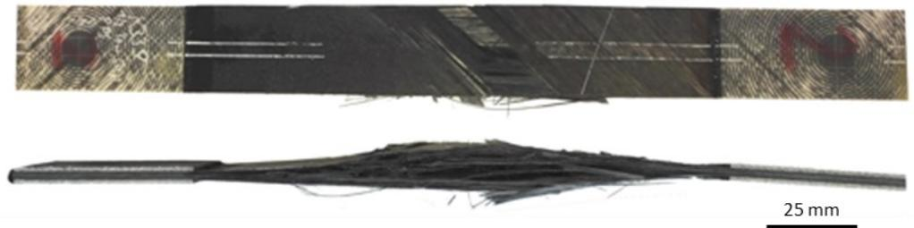
**Abb. 5-56: Typische Versagensform Zugversuch**
