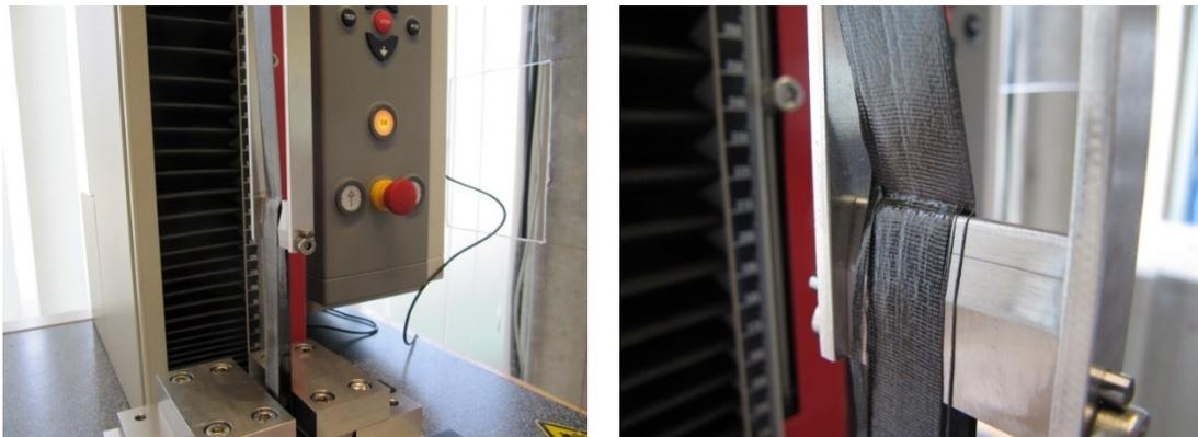
**Abb. 4-4: Ungewolltes Deckschichtversagen einer Probe aus CF/PPS im Vorversuch**
