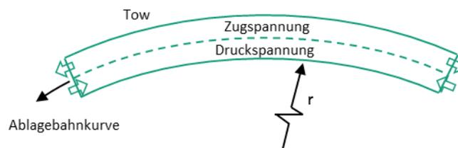
Abb. 2-13: Spannungszustand eines Tows bei der Ablage entlang von nicht-geodätischen Pfaden
