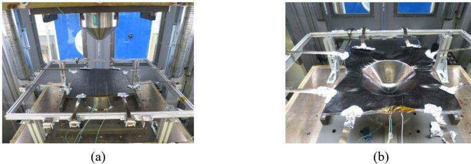
**Abb. 5-3: Umformung Kegelgeometrie**
