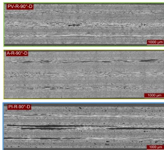
**Abb. 5-43: Schliffbilder von konsolidierten Laminaten ohne Fehlstellen**
