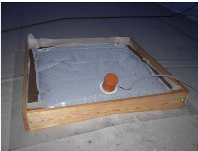
Abbildung 40: Schneekissen in Rahmenvariante „First“, fertig befüllt und verkabelt
