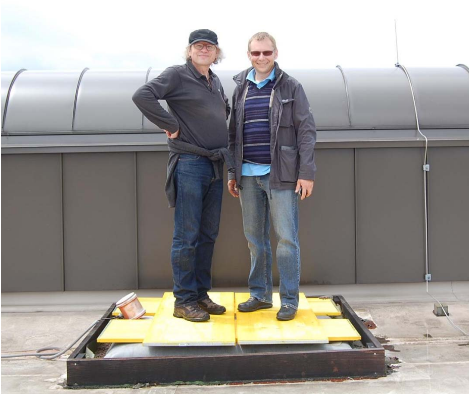
Abbildung 50: Belastung des östlichen Schneekissens mit Mannlast
