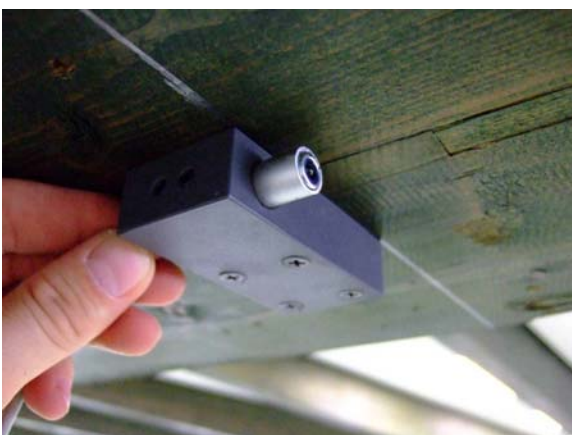
Abbildung 21: LED eines Messpunktes während der Montage mit Halterung aus Stahl
