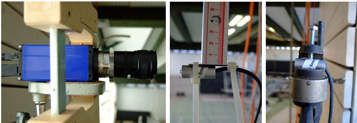
Abbildung 13: Vorversuche in der Turnhalle in Murnau: Kamera (links), verschiebbliche Mess-LED (Mitte) und Referenz-LED (rechts)
