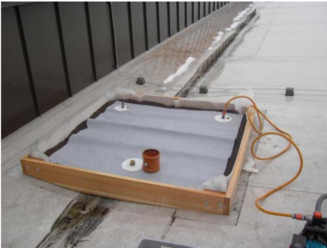
Abbildung 39: Schneekissen in Rahmenvariante „Graben“, während des Befüllvorgangs
