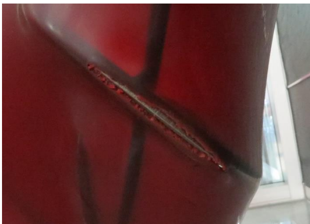
Abb. 34: Detail Spannungsriß an Metallstrebe (Ausschnitt etwa 15 cm groß) (Foto: JS 11.2017)
