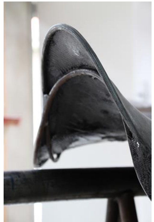
Abb. 14: Detail der Carbonfaserlamine bei der Herstellung (Foto: JS, Juli 2017)
