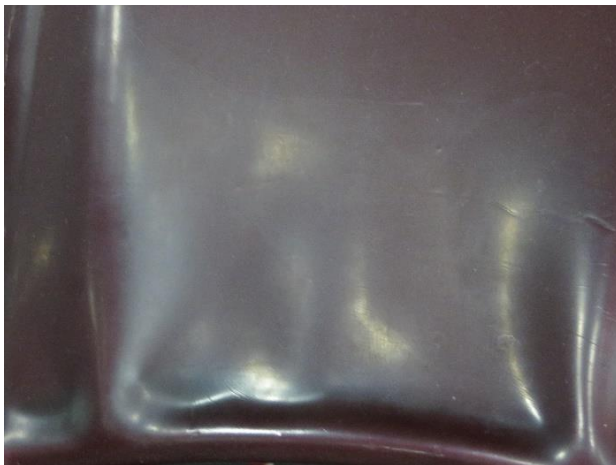
Abb. 37: Detail Wölbung durch Spannungsverschiebung (oben) Ausschnitt etwa 15 cm groß (Foto: JS, 11.2017)
