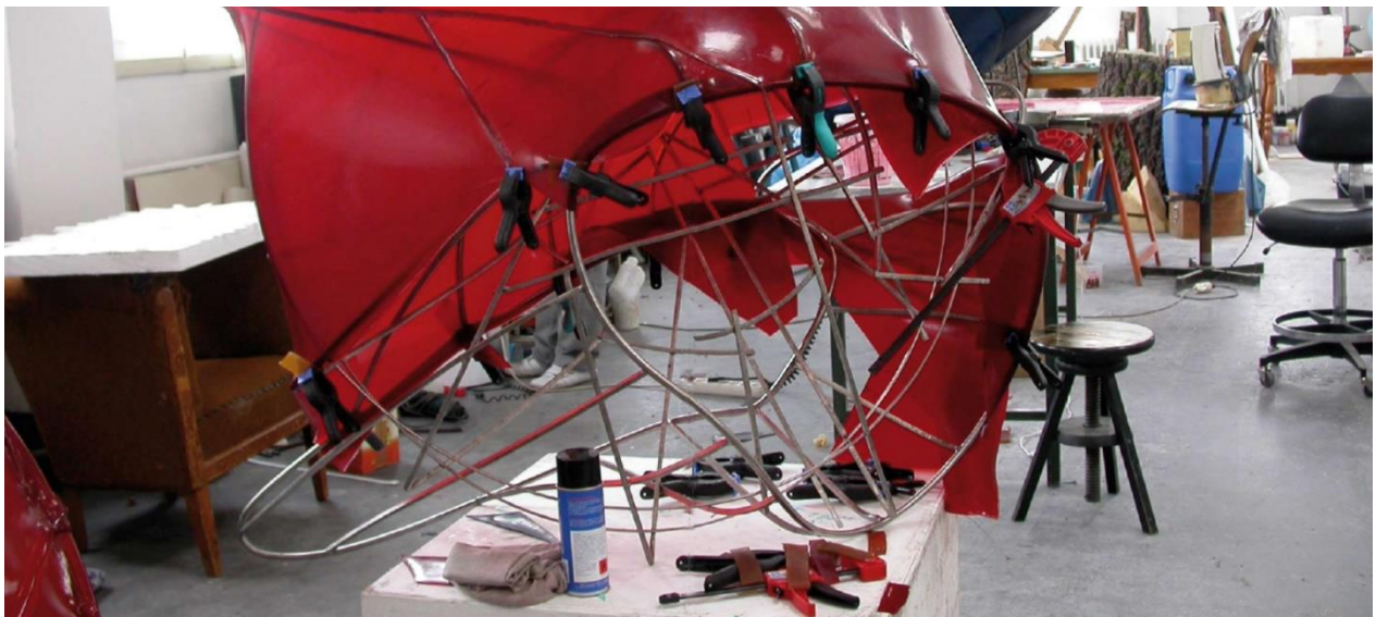
Abb. 21: Metallgerüst während der Bespannung mit Naturkautschuk (Foto: ZERN (Hrsg.) 2008, S. 68/69)
