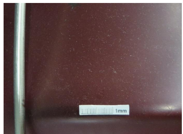
Abb. 29: Detail Verschmutzung durch lose aufliegende Partikel (Foto: JS, 11.2017)
