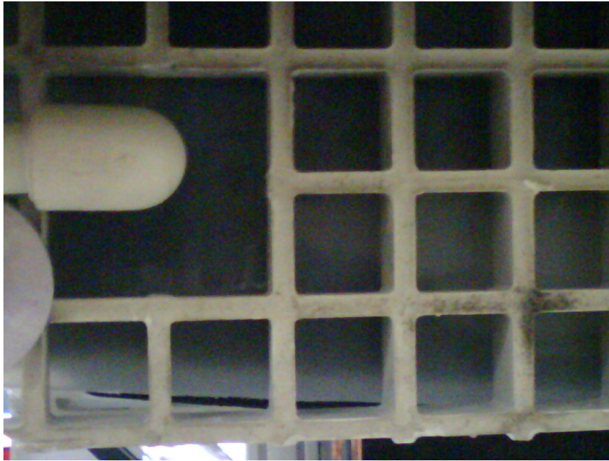
Abbildung 40: Bild der Austauschfläche mit Stützkonstruktion
