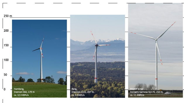
Abb. 10 Typen und Dimensionen von Windenergieanlagen in der Region und aktueller Schwach- und Mittelwindanlagen unter Verwendung von Fotos von S. Schöbel (r., l.), R. Sing (m.)
