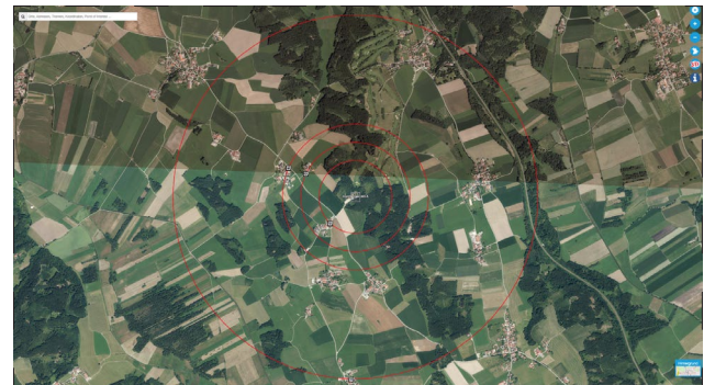
Abb. 13 Visuelle Wirkung von Windenergieanlagen in der Landschaft am Beispiel der Bestands-WEA Hamburg: 2H-, 3H-, 4H- und 10H-Abstände (Kartendarstellung) unter Verwendung von Satellitenbildern aus dem Bayern-Atlas
