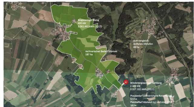
Abb. 12 Vergleich Flächenbedarf der Bestands-WEA im Landkreis (Hamburg) mit dem Flächenbedarf einer benachbarten Biogasanlage mit vergleichbarem Strom-Jahresertrag unter Verwendung von Satellitenbildern aus dem Bayern-Atlas
