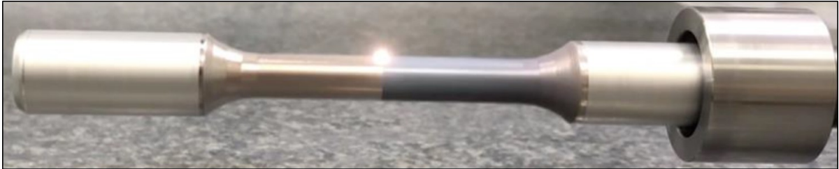
Abbildung 3.6: Probe während der ersten Stufe des Laserpolierens, links glanzpoliert, recht umgeschmolzen.
