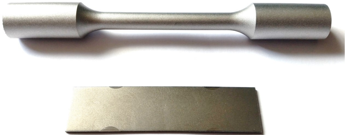
Abbildung 3.7: Verfestigungsgestrahlte Probe mit dem dazugehörigem Almenstreifen.
