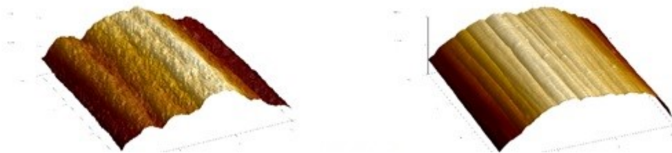
Abb. 8-7: SGL Sigratex C-Faser vor der Pyrolyse (links) und nach der Pyrolyse (rechts) [164]
