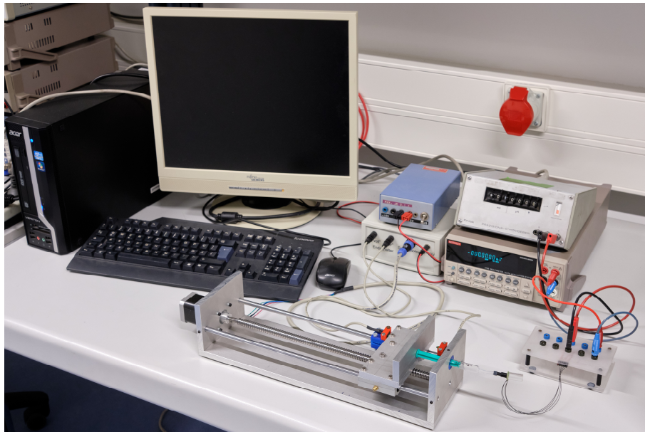
Abbildung 57: Experimenteller Messplatz zur Charakterisierung der miniaturisierten Anemometer.
