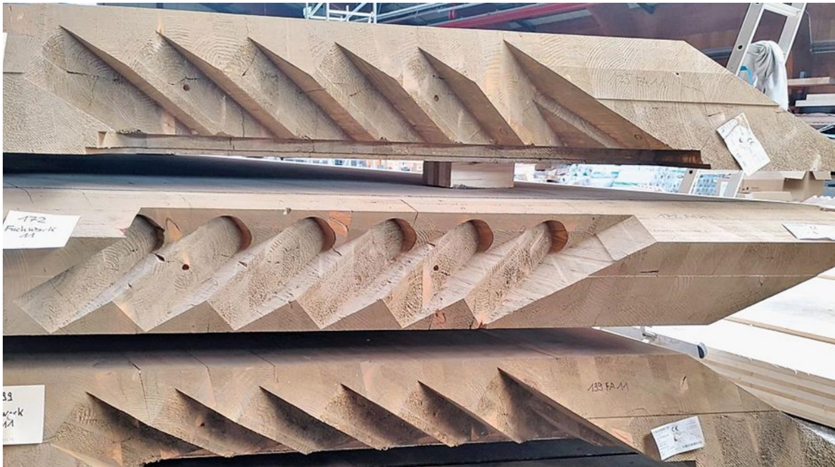
Abbildung 18: Gefräste Schubverbindung, © Derix-Gruppe
