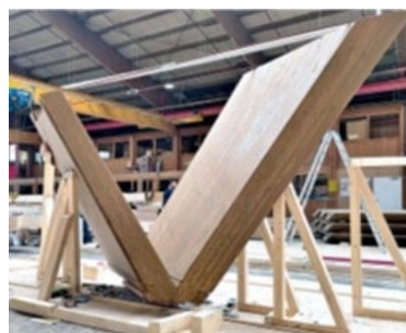
Abbildung 2: Mockup Fassadenstütze © Derix-Gruppe
