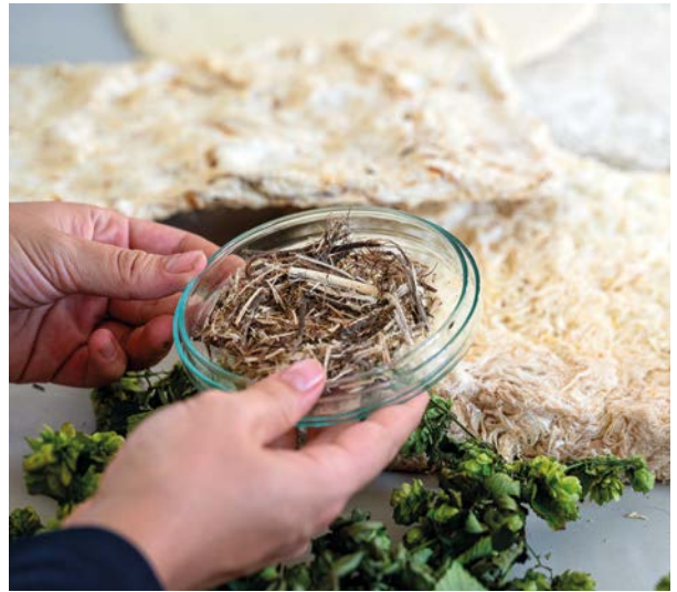
In einem ersten Schritt im Herstellungsprozess der Baumaterialien werden die Fasern der Hopfenreben mechanisch getrennt.
