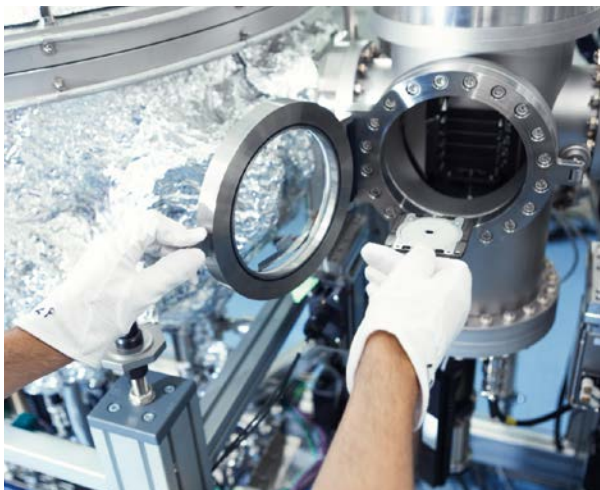
Ein Doktorand bringt ein Substrat zur Beschichtung in ein Depositionssystem für hochreine supraleitende Schichten ein.
