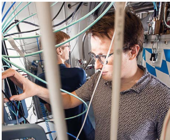
Kirill Fedorov (vorn) führt Spektroskopie-Messungen von supraleitenden Quantenschaltkreisen durch, die sich im Verdünnungskühlschrank hinten im Bild befinden.
