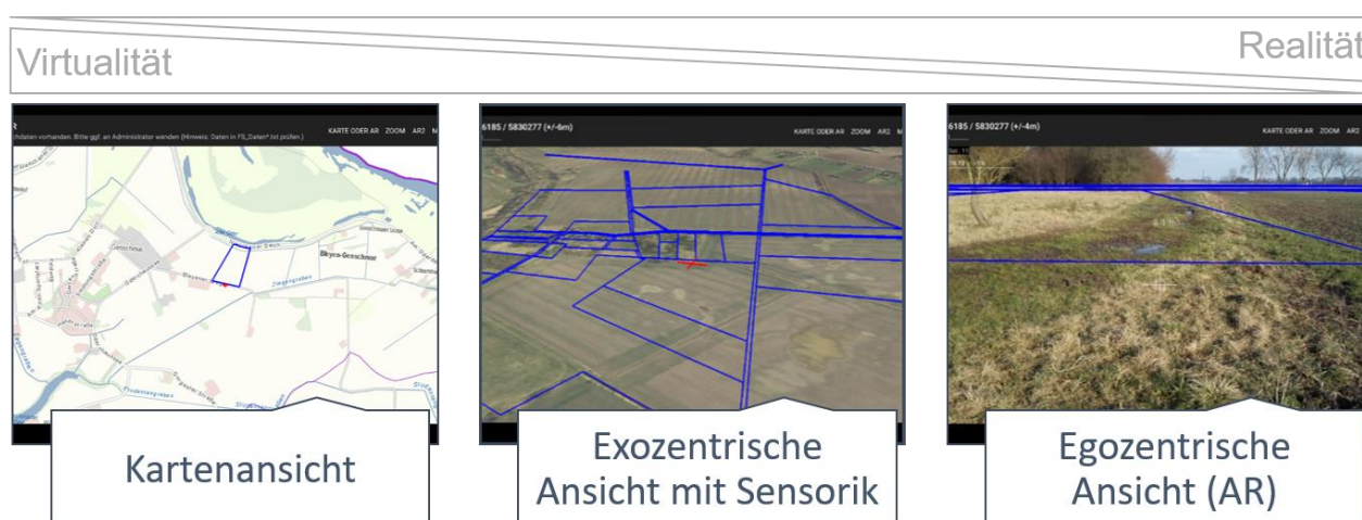
Abb. 1: Formen der AR-Darstellung; hier: Bildschirmfotos einer GeoARS-Applikation mit Topographischer Karte WMS (links), Digitalem Orthophoto WMS (Mitte) und Live-Kamerabild (rechts), jeweils überlagert mit WFS-Flurstücksgeometrien.
