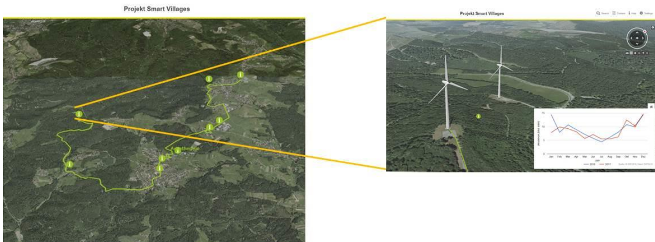
Abb. 2: Fachspezifische Daten wie umweltrelevante Sensordaten, z.B. der Stromertrag von Windkraftanlagen, werden zum Monitoring in die Plattform integriert und können für weitere Simulationen genutzt werden. Eigene Darstellung mit Diagramm des Windenergie-Branchenportals ( https://www.windbranche.de/wind/windstrom/windenergie-deutschland ).
