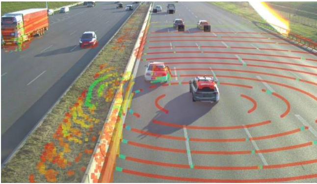
Abb. 3: Integration der LiDAR-Messdaten des fortiss Forschungsfahrzeugs in das Sensorsystem von Providentia.
