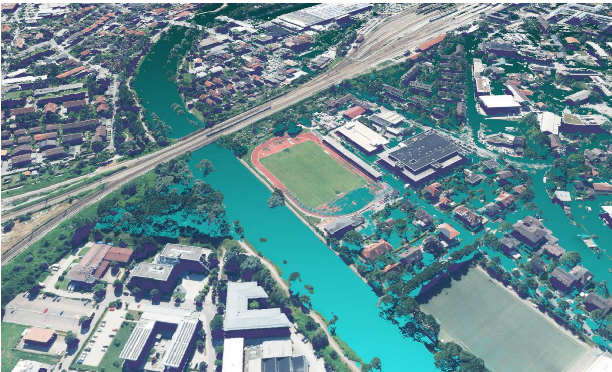
Abb. 3: Visualisierung eines HydroAS-2d Modellierungsschritte (hellblau) an der Mangfall in HydroVISH zusammen mit RGB-eingefärbten DOM zur verbesserten Beurteilung des zeitlichen Verlaufes und der räumlichen Ausbreitung eines HQ100-Ereignisses.
