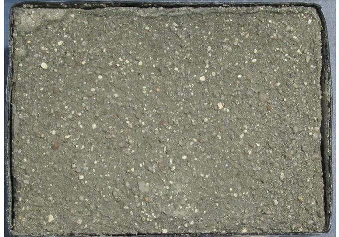
**Abbildung 12** Oberfläche eines Probekörpers der Prüfkörperserie M-0.55-I bei Vorlagerung V65 nach 28 FTW
