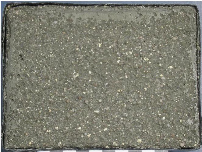
**Abbildung 10** Oberfläche eines Probekörpers der Prüfkörperserie M-0.40-I bei Vorlagerung V85 nach 28 FTW
