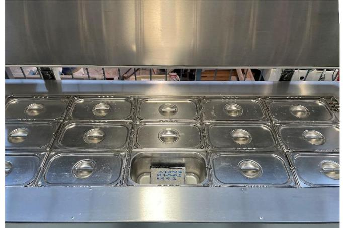
**Abbildung 3** Frosttruhe mit Prüfbehältern für CDF-Prüfkörper
