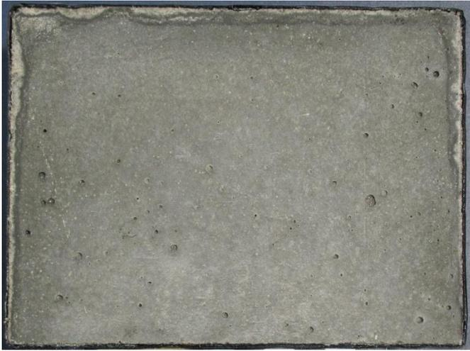
**Abbildung 9** Oberfläche eines Probekörpers der Prüfkörperserie M-0.40-I bei Vorlagerung V85 vor der Frost-Tausalz-Wechsel-Belastung
