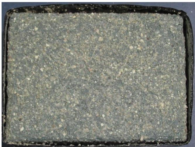
**Abbildung 15** Oberfläche eines Probekörpers der Prüfkörperserie M-0.55-III bei Vorlagerung V65 nach 28 FTW
