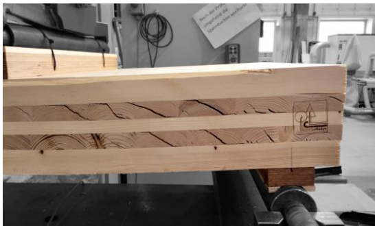
a) Referenz Fichte F-0: Rollschubversagen
