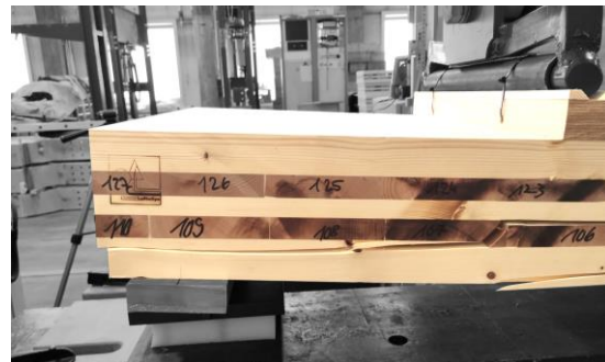
b) Referenz Buche B-0: Längsschubversagen
