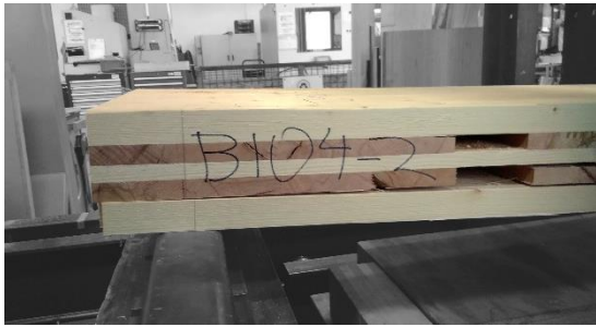
e) aufgelöste Variante mit Auflagerverstärkung B-4: Längsschubversagen an der Auflagerverstärkung
