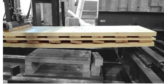
d) aufgelöste Variante ohne Auflagerverstärkung B-1: Abrollen der Querlagenbretter
