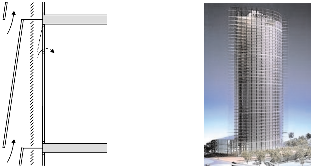
Abbildung 2.3: Neubau Generaldirektion Deutsche Post AG: Einsatz von CFD-Simulationen zur Entwicklung angepasster Fassadengeometrien und -konzepte (Architekten: Murphy / Jahn), 2001; Modellfoto: [113]
