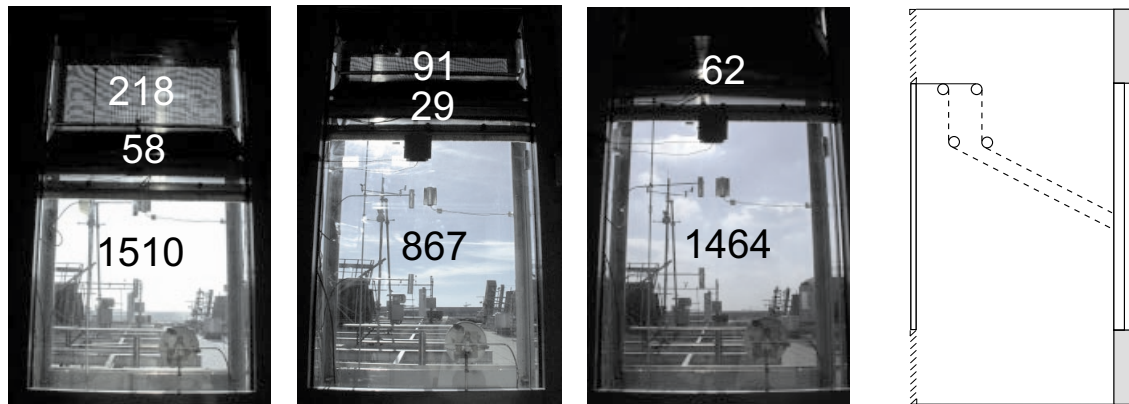
Abbildung 5.23: Typische Leuchtdichten bei Blendschutz-Konfigurationen mit zwei identischen Matrixgeweben ( \psi = 0.38 ) unter Variation der Sonnenhöhe \gamma_S ( 20^\circ , 25^\circ , 30^\circ ) und des darauf eingestellten Neigungswinkels der Matrixgewebe \gamma_M ( -55^\circ , -50^\circ , -40^\circ ), jeweils von links nach rechts
