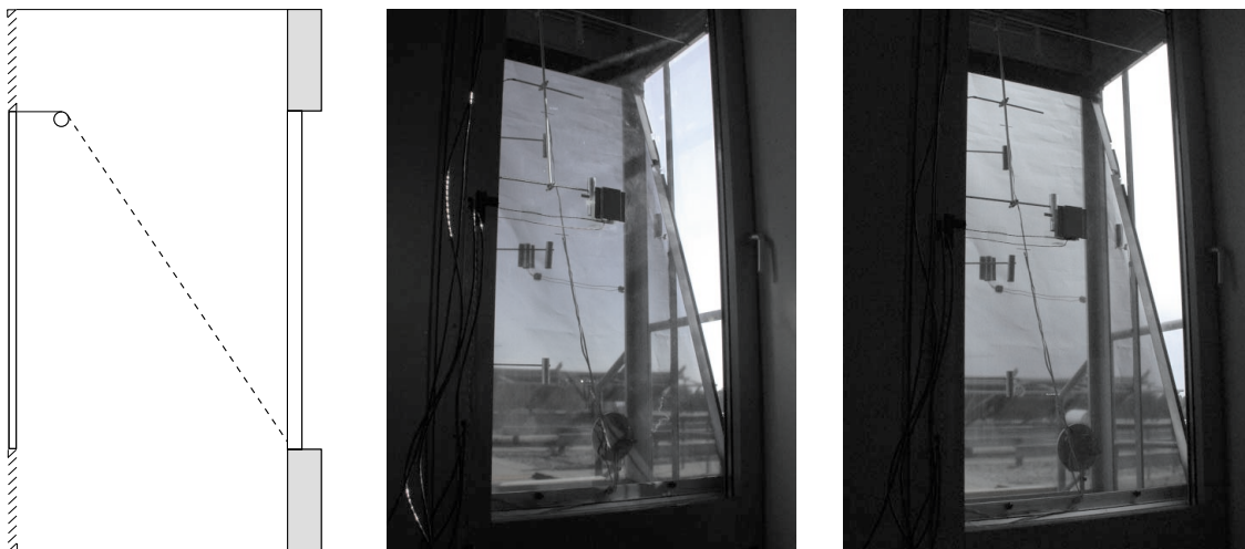
Abbildung 5.16: Innenansicht eines Fensterkastens einzelner Matrix ( \psi = 0.31 ) in negativem Neigungswinkel ( -20^\circ ), links an einem klaren Tag, rechts an einem trüben bzw. diesigen Tag
