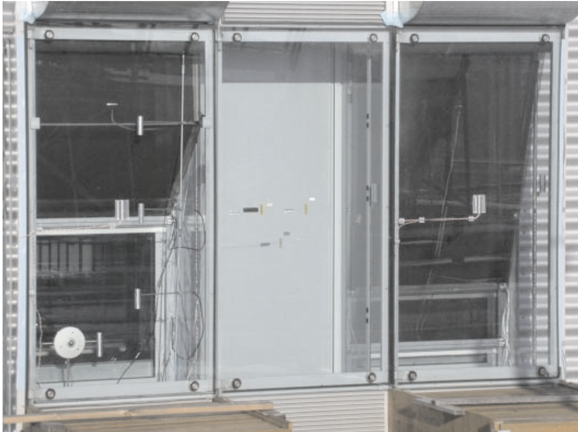
Abbildung 5.18: Außenansicht der Testfassade bei unterschiedlicher Matrixkonfiguration in FK 1 (rechts, Standardkonfiguration mit \gamma_M = -20^\circ ) und FK 2 (links, Sonderkonfiguration mit \gamma_M = 0^\circ bzw. \gamma_M = -45^\circ )
