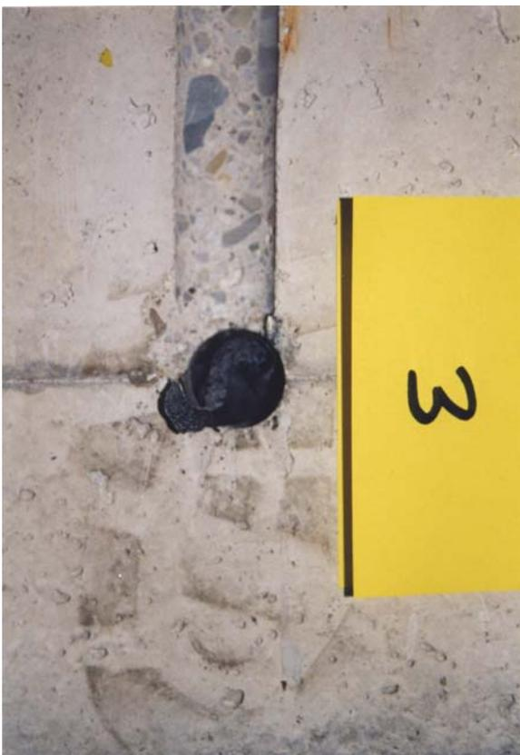
Betonoberfläche der Fuge der belasteten Balkenhälfte nach Versuchsende bei Probekörper 3 mit 80 mm Dübeleinsenlänge. Nur oberflächliche Abplatzungen mit geringer Tiefe.
