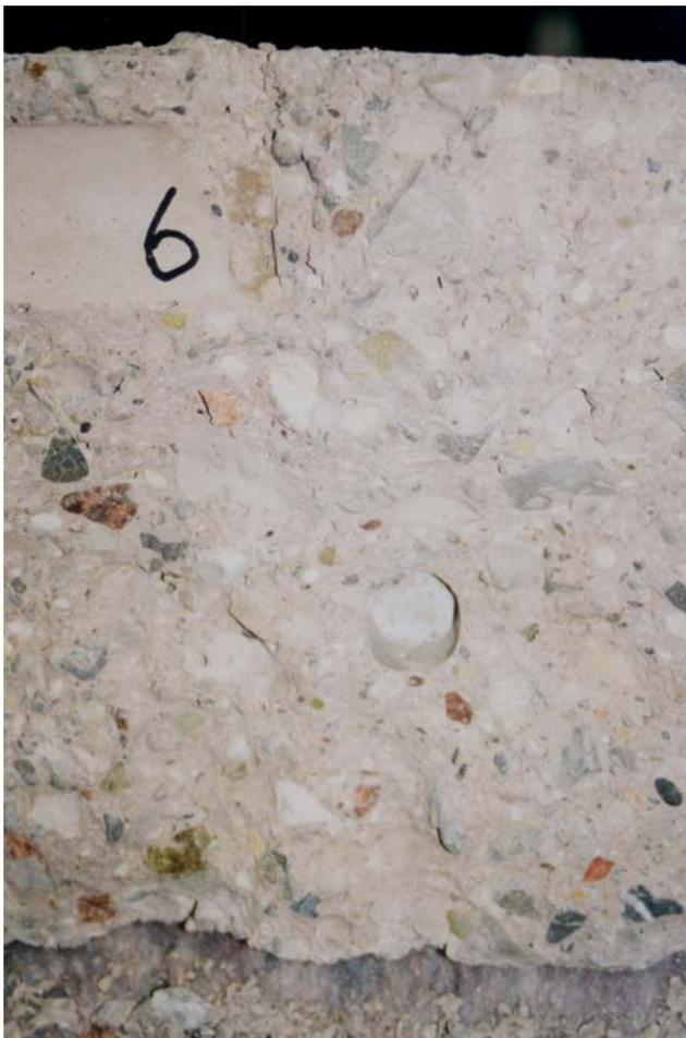
Dübelloch 6 mit einer mittleren Dübeleinbindelänge von 20 mm
