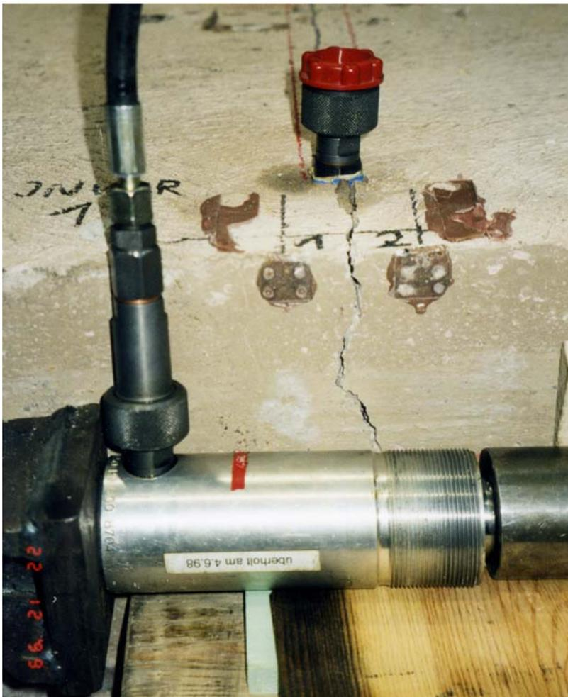
Hydraulikzylinder zum Öffnen der Fugenkonstruktion
