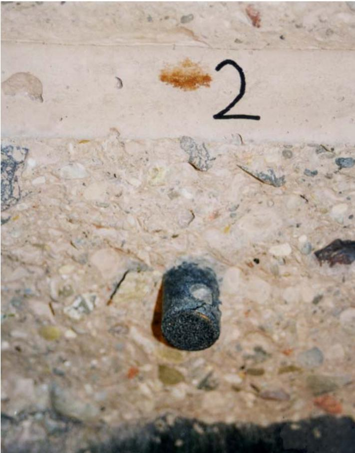
Dübel 2, der für Induktivwegaufnehmer 26 an der Oberseite angebohrt wurde
