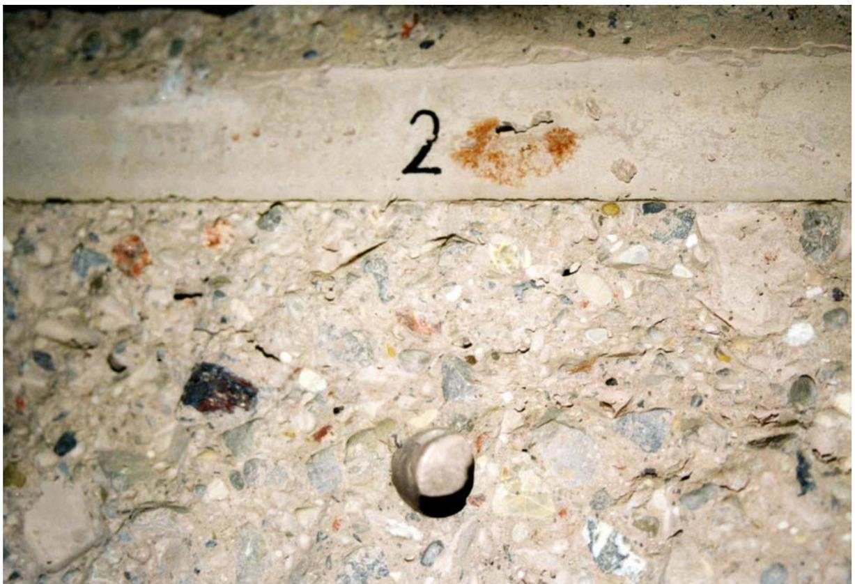
Dübelloch 2 mit Bohrloch  $\varnothing$  10 mm an der Oberseite für Induktivwegaufnehmer 26
