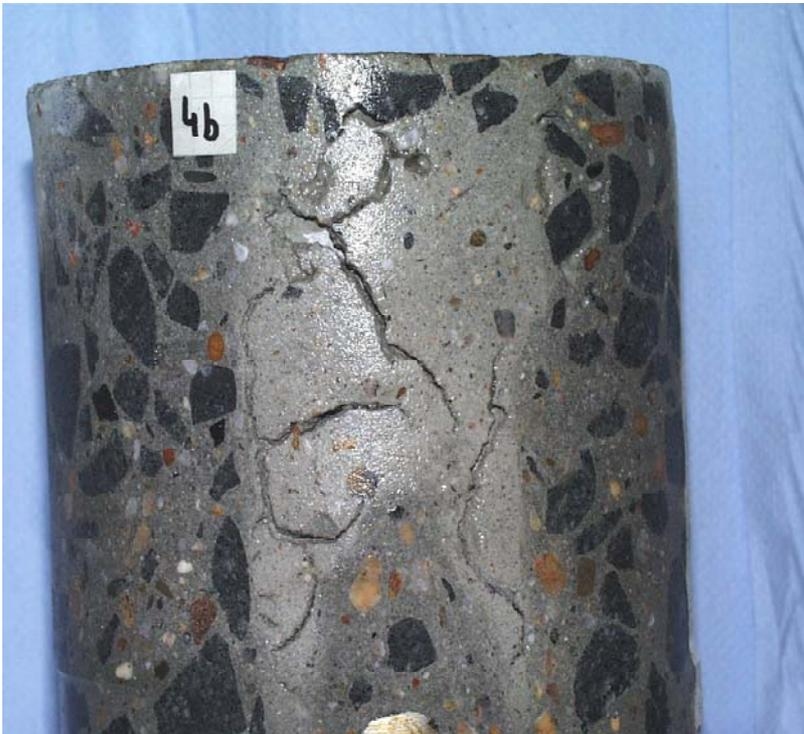
Detailaufnahme des oben dargestellten Bohrkerne. Über dem Dübel sind deutlich die durch das Einrütteln der Dübel veränderte Struktur des Betons und die Schwindrisse im Beton zu erkennen /29/.
