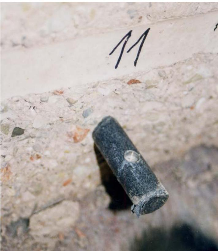
Dübel 11 mit Bohrung für Induktivwegaufnehmer 25
