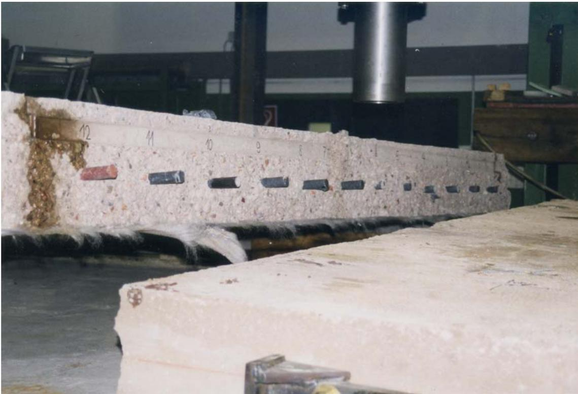
Angehobene nördliche Plattenhälfte mit auskragenden Dübeln
