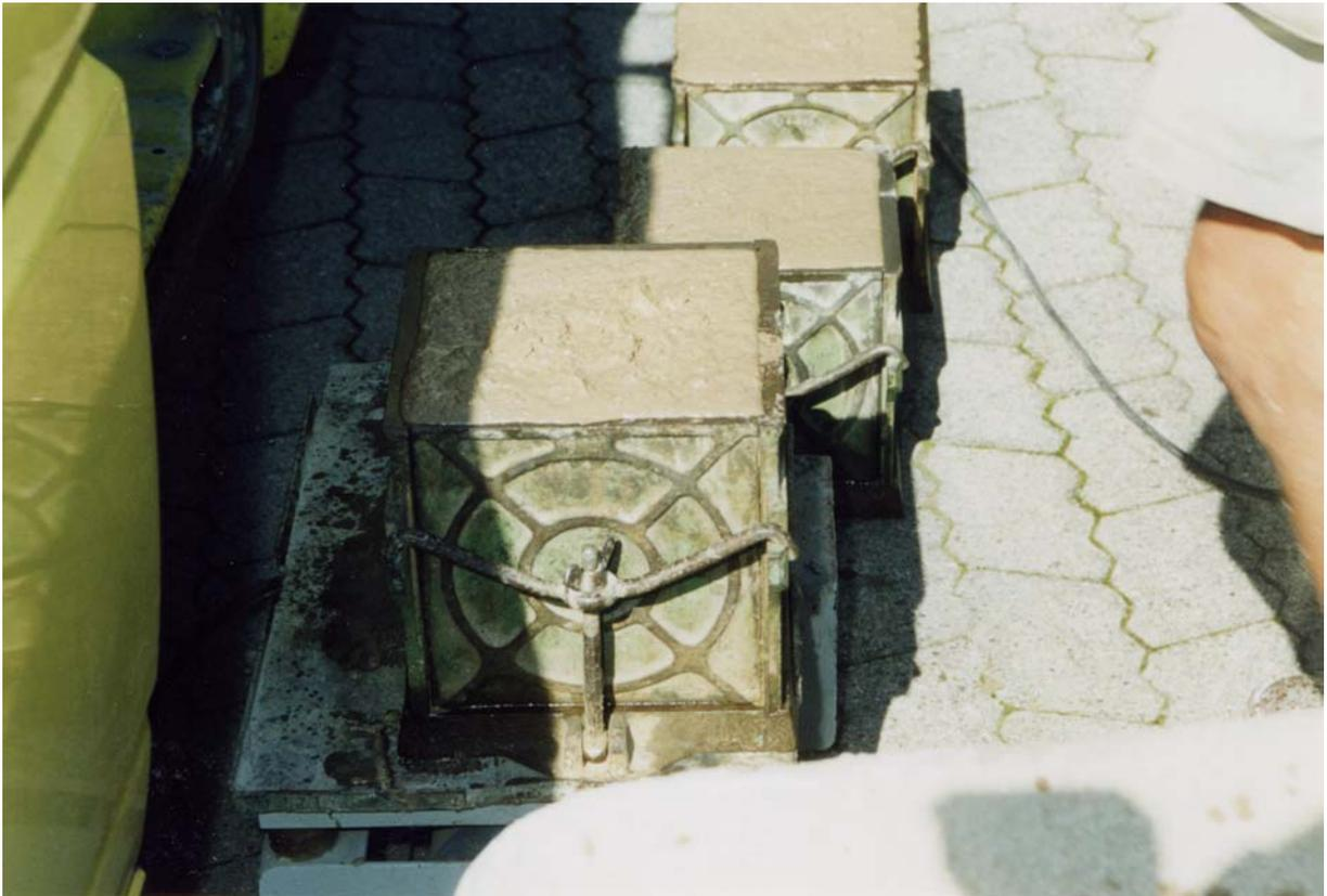
Herstellen der Probekörper im Rahmen der Eigenüberwachungsprüfung
