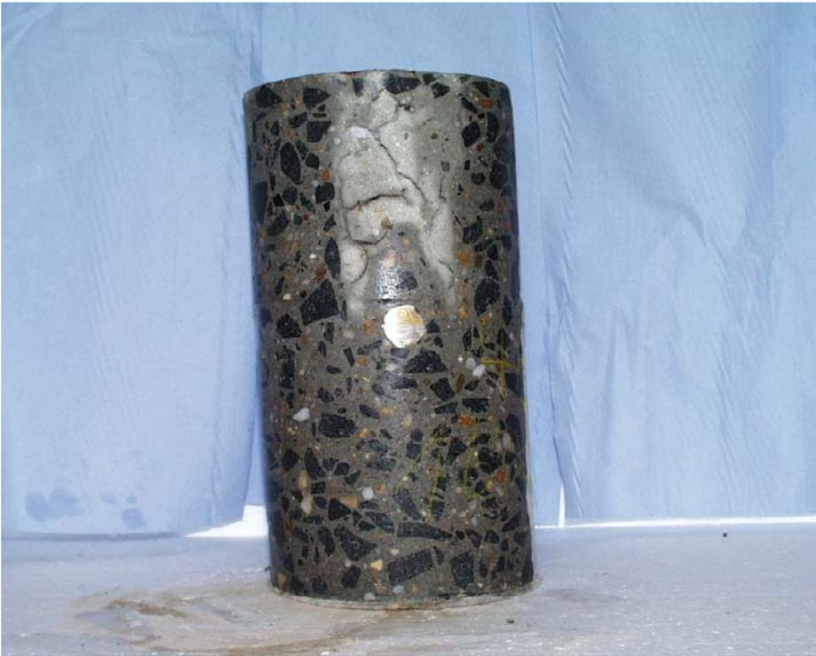
Bohrkern aus einlagiger Betondecke mit mittiger Dübellage /29/
