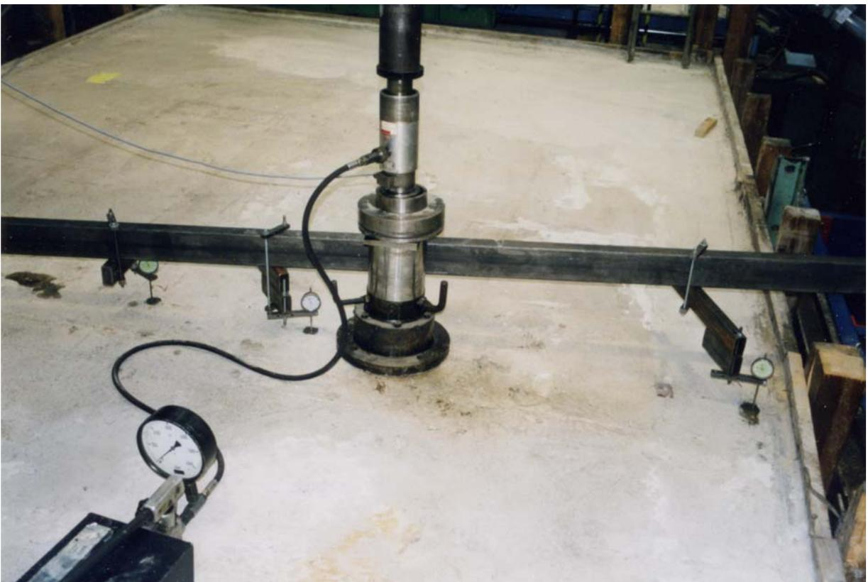
Belastungsplatte mit Gummiunterlage und Messbasis mit Messuhren zur Bestimmung der Untergrundsteifigkeit des bestehenden Versuchsaufbaus
