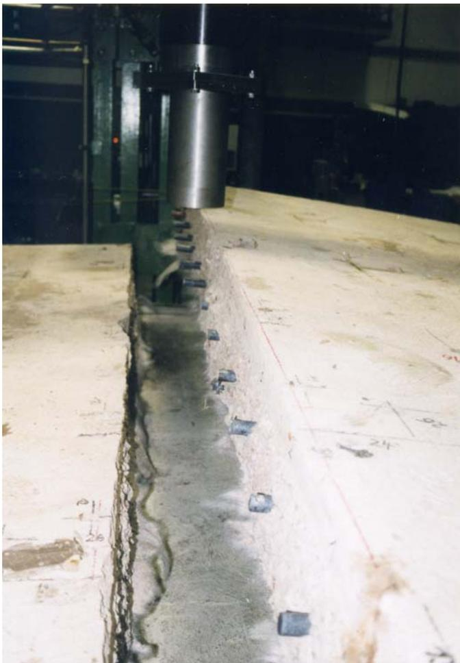
Mittlere Dübeleinsenkungen von 68 mm bzw. 30 mm
