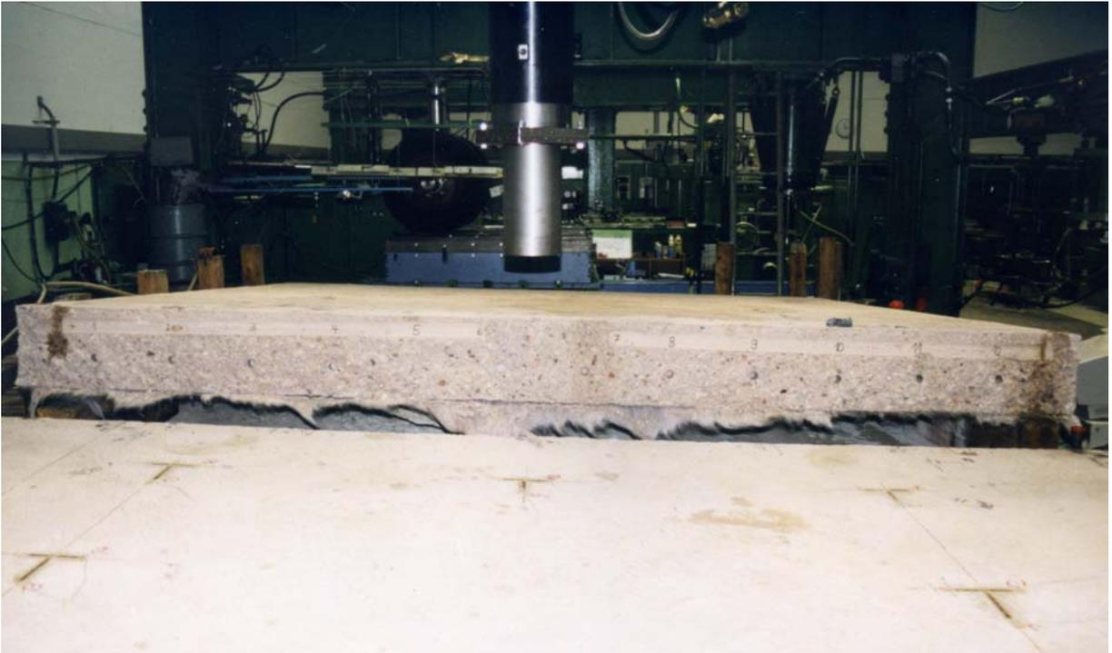
Fugenstirnfläche der nördlichen Betonplattenhälfte mit Dübellöchern
