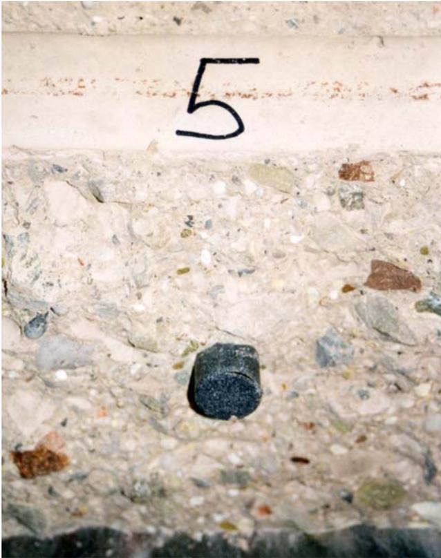
Dübel 5 mit einer mittleren Einbindelänge von 24 mm
