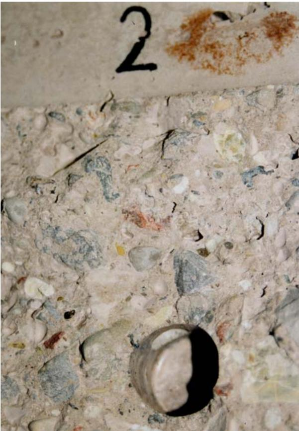
Dübelloch 2 mit Rissstruktur des Betons
