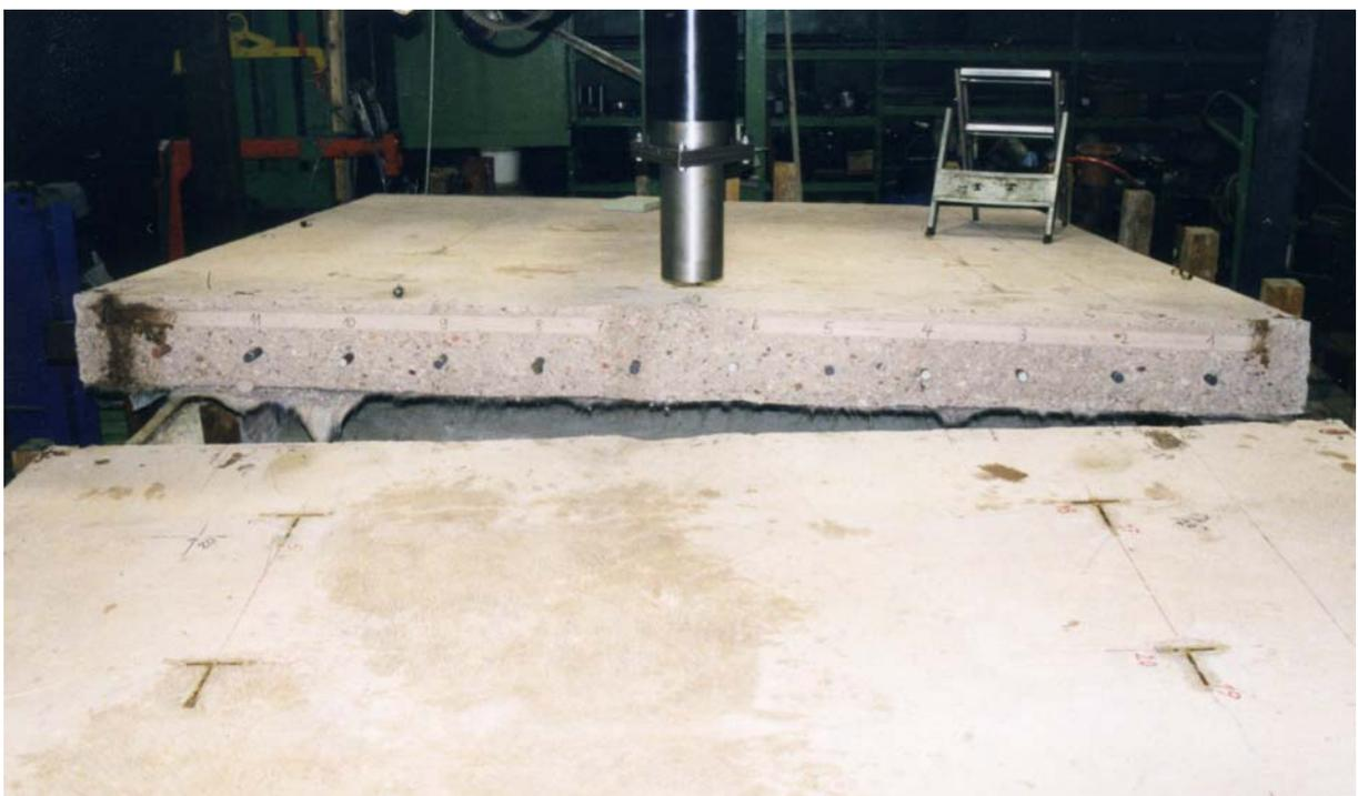
Fugenstirnfläche der südlichen Betonplatte mit auskragenden Dübeln
