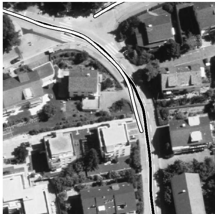
**Abbildung 63.** Überlagerung der Achsen von Fahrschulden aus verschiedenen Bildern. Lageabweichungen der Fahrschulden können größer als eine halbe Fahrschuldenbreite sein, so dass eine eindeutige Zuordnung von Fahrschulden nicht unbedingt gewährleistet ist.
