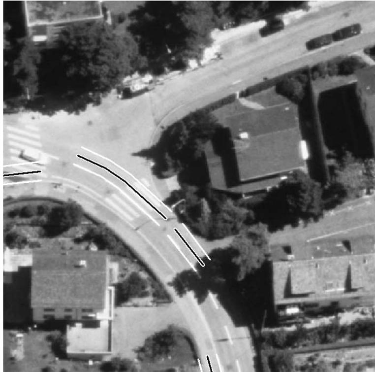
**Abbildung 45.** Extraktion von Fahrspuren aus Markierungen mit hypothetischen Fahrspurbegrenzungen.
