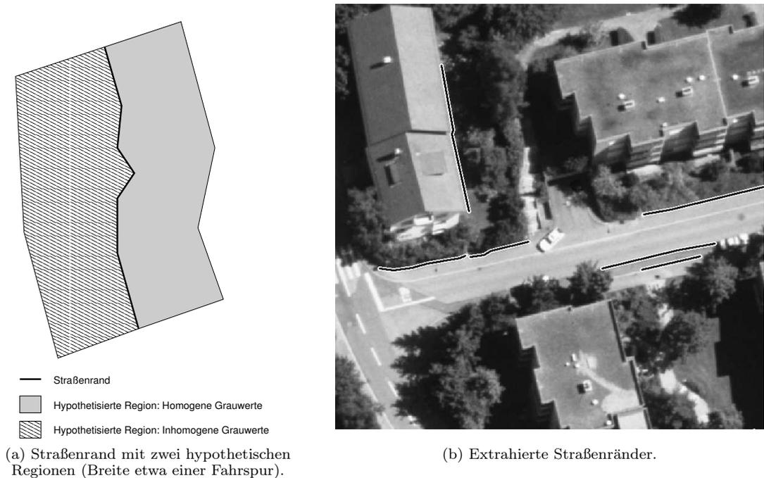
**Abbildung 41.** Extraktion von Straßenrändern: Man beachte auch die Fehlextraktion an der Dachkante. Sie kommt zustande, weil die Dachfläche homogen ist und im Zuge der Kontextanalyse nicht die gesamte Hausregion eliminiert werden konnte.
