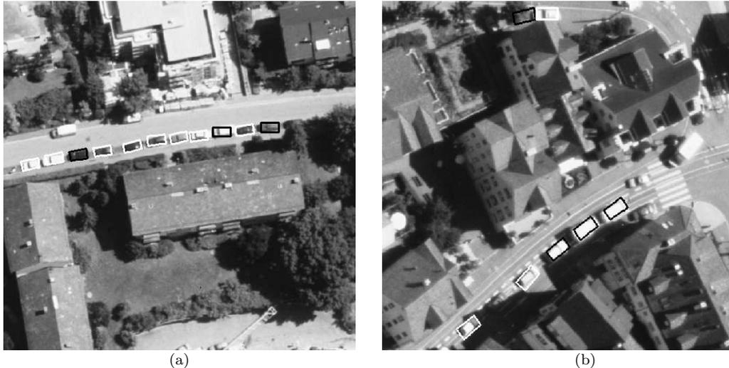
**Abbildung 32.** Ergebnisse der gesamten Fahrzeugextraktion: Weiß: Ergebnisse aus Fahrzeugdetektion. Schwarz: Durch Fusion mit Kolonnendetektion zusätzlich detektierte Fahrzeuge.
