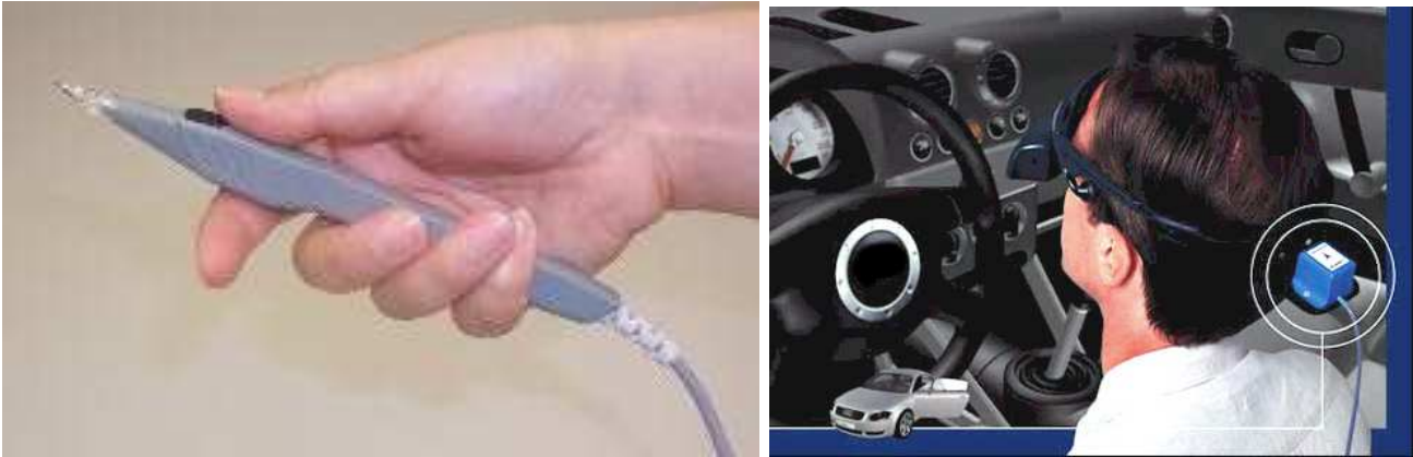
Abbildung 2.5: Beispiele für Eingabe-Geräte: Stylus (Wand, links) und Positions-Tracking (rechts)
