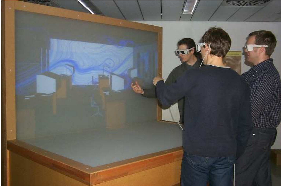
Abbildung 6.20: Kombinierte Darstellung von CAD-Daten und Ergebnissen der Simulation in Virtual Reality
