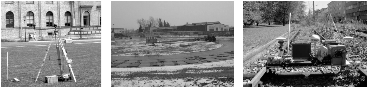
Abbildung 5.4: verschiedene Bewegungssimulatoren zur Untersuchung von GPS- und TPS-Sensoren
