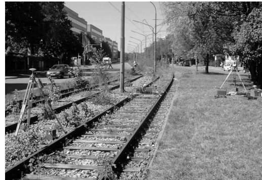
Abbildung 5.7: Schienensystem zur Kalibrierung des Gesamtsystems (München Boschetsrieder Str.)
