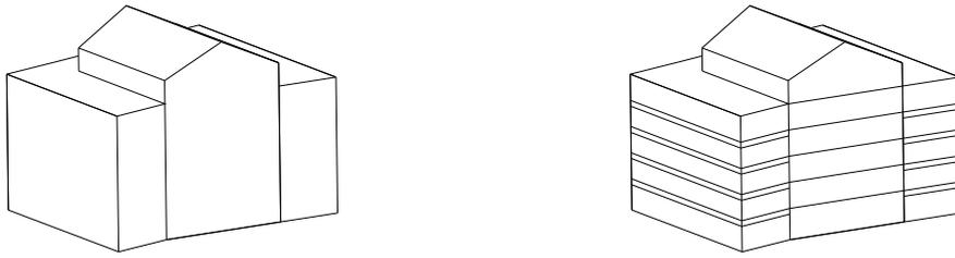
Abbildung 2.18: Modellbildung in SMILE: einfaches Modell (links) und detailliertes Modell (rechts).
