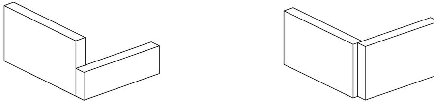
Abbildung 3.21: Zueinander versetzte Bauteile: Der links abgebildete Fall ist zulässig, der rechte aber nicht, da hier bei der Zerlegung die Wandscheibe in mehrere Schichten zerfallen würde. Letztgenannter Fall wird aber dadurch aufgefangen, dass alle Wandschichten zuvor entsprechend miteinander verschnitten werden.
