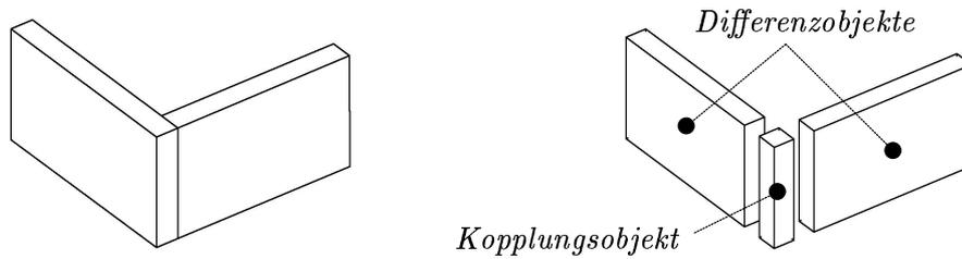
Abbildung 3.18: Zerlegung zweier sich stumpf stossender Bauteile (z.B. Wände) der Menge  $\Omega$  in *Kopplungs-* und *Differenzobjekte*
