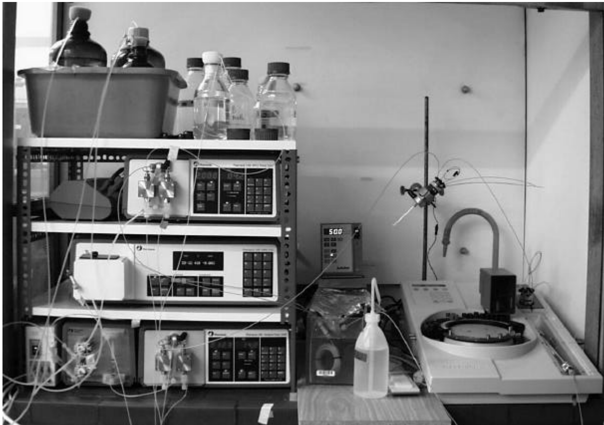
Abbildung 18: Verwendete HPLC-Anlage: Autosampler mit Injektionsventil und RP-Säule (rechts); Wasserbad mit Derivatisierungsschleife (Mitte); Laufmittel, HPLC-Pumpe für Derivatisierungsreagenz, UV/Vis-Detektor, HPLC-Gradientenpumpe mit Low Pressure Mixer und Entgaser (links von oben).
