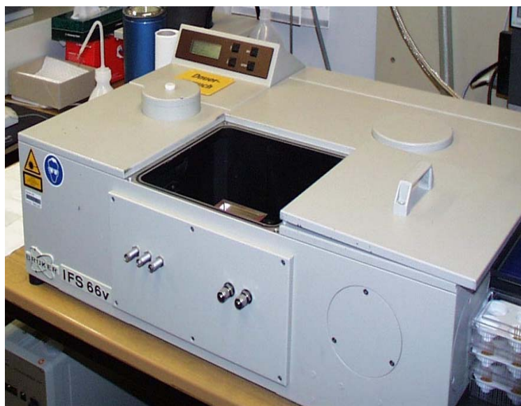
Abbildung 49. FTIR-Spektrometer Bruker IFS 66v, mit dem im MIR-Spektralbereich mittels DRIFT- und ATR-Technik die Messungen erfolgten.
