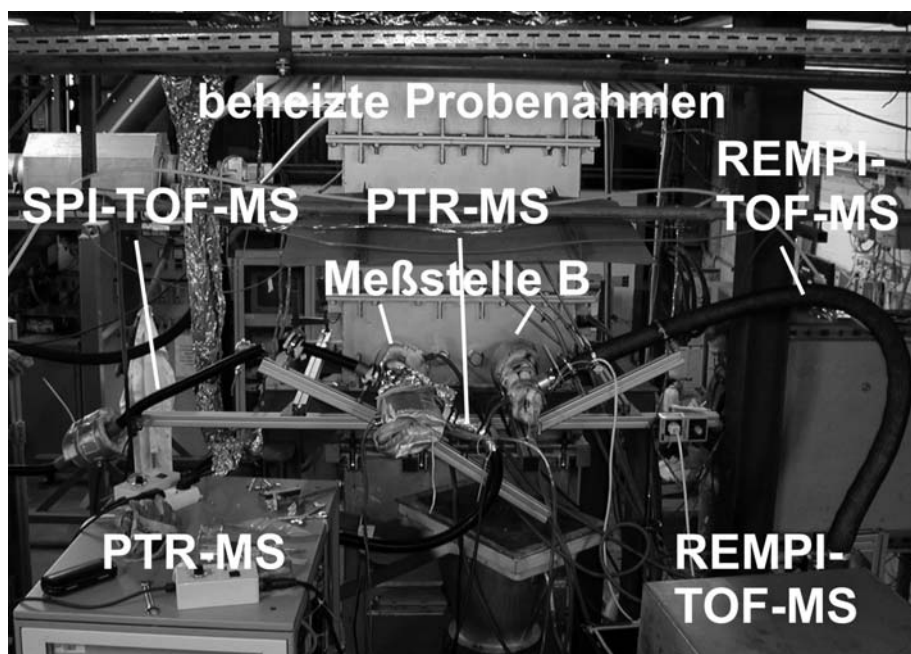
Abbildung 53: Probenahmeaufbau für das REMPI-TOFMS-Spektrometer am Chargenrost des IEVB
