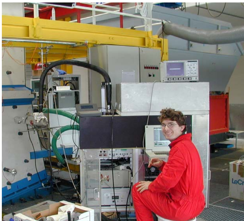
Abbildung 88: Foto des REMPI-TOFMS-Gerätes an der Pilotanlage. Zu erkennen sind die Probenahmestelle sowie der Brennstoffbehälter, welcher den Brennstoffvorrat für eine kontinuierliche Beschickung bereitstellt (oben rechts)
