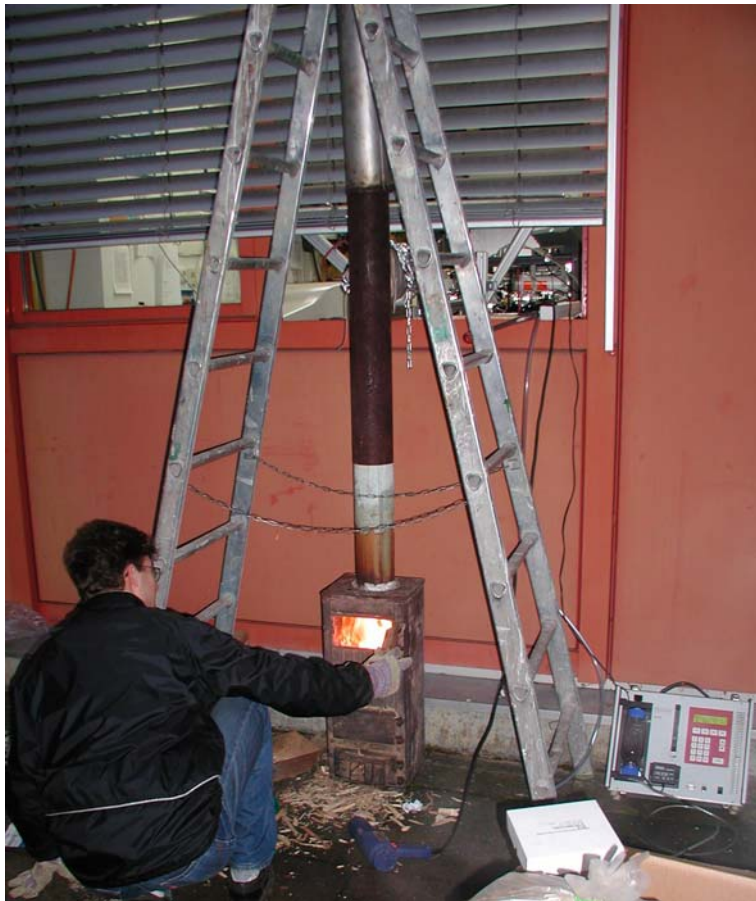
Abbildung 31: Messungen am 5 kW-Ofen für Hausbrand am GSF-Forschungszentrum. Die Probenahme und das REMPI-TOFMS-Spektrometer befinden sich im Innern des Gebäudes
